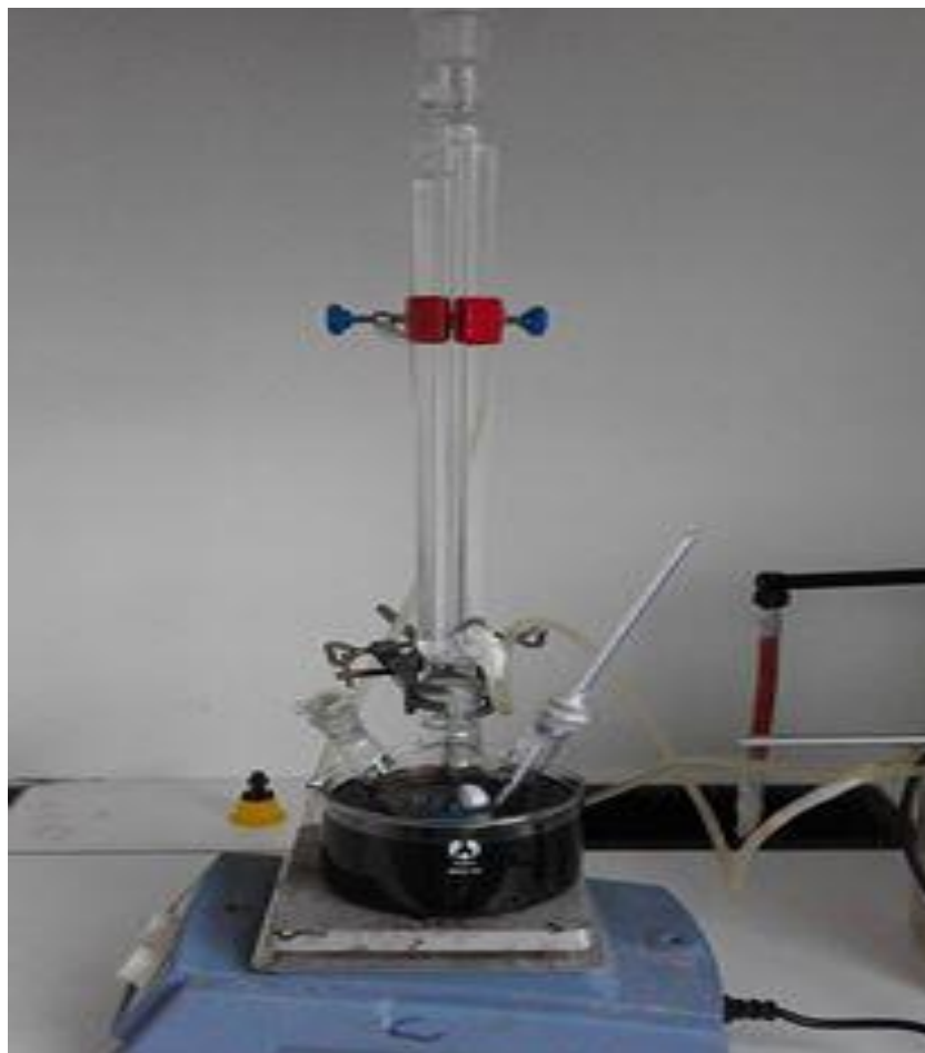
Figure II-III-3-Montage à reflux de l'élaboration du blend PVPh/POM.
