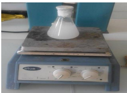
Figure II-III-1-Elaboration des blends binaires par la méthode de mélange en solution.
