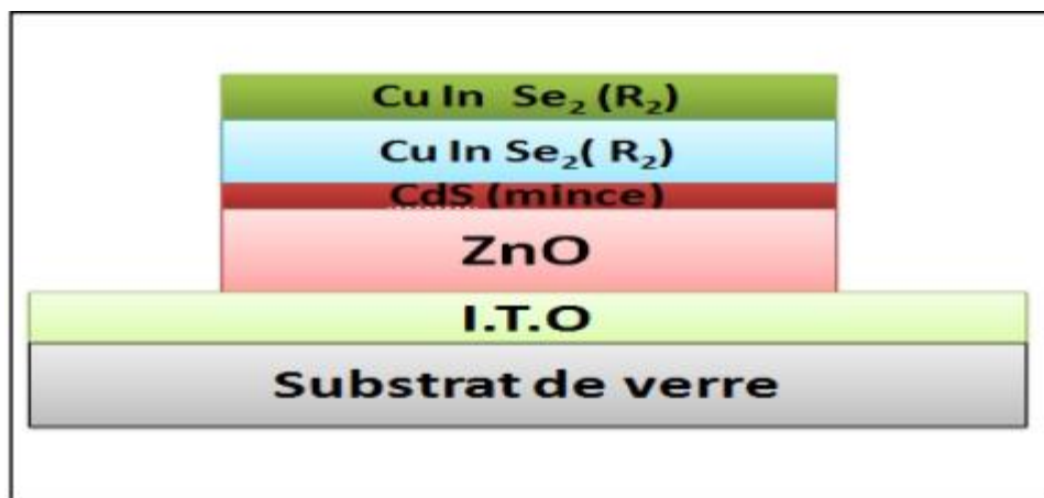
Figure I.4: La structure de base d'une cellule solaire. [41]
