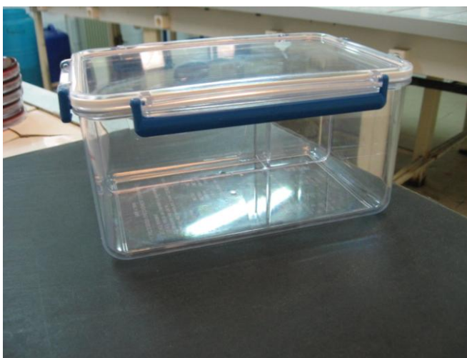
Figure 13 : Photo d'une jarre d'incubation
