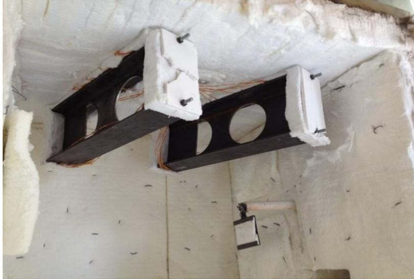
**Figure 4.12.** Poutres P12 et P15 avant l'essai au four.
