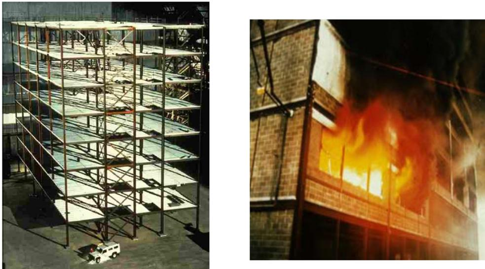
Figure 5.24. Bâtiment de Cardington en construction et durant l'essai
