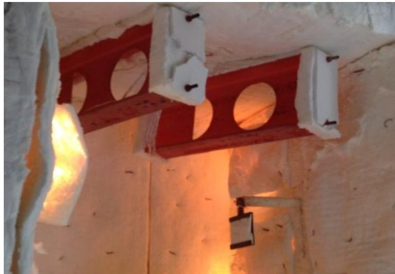
**Figure 6.21.** Poutre cellulaire P5 dans le four
