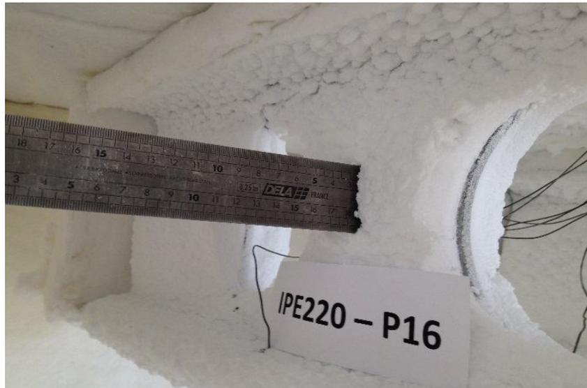
**Figure 4.28.** Expansion du revêtement intumescent de l'essai P16 en fin de l'expérimentation
