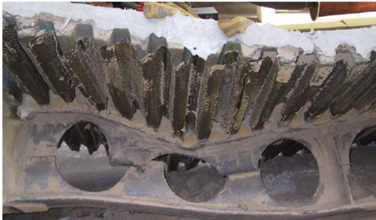
**Figure 2.1.** Ruine d'une poutre cellulaire après essai sous incendie [67]
