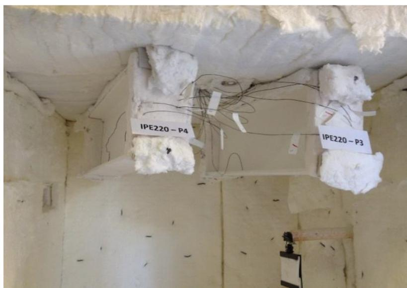
**Figure 4.14.** Poutres P4 et P3 avant l'essai au four
