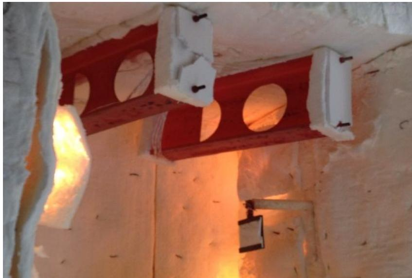
**Figure 4.13.** Poutres P12 et P15 après l'essai.
