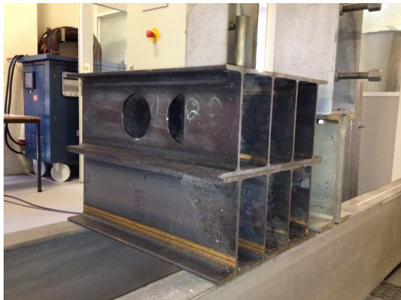
**Figure 4.2.** Découpe et réalisation des profilés de poutres à âmes pleines et cellulaires
