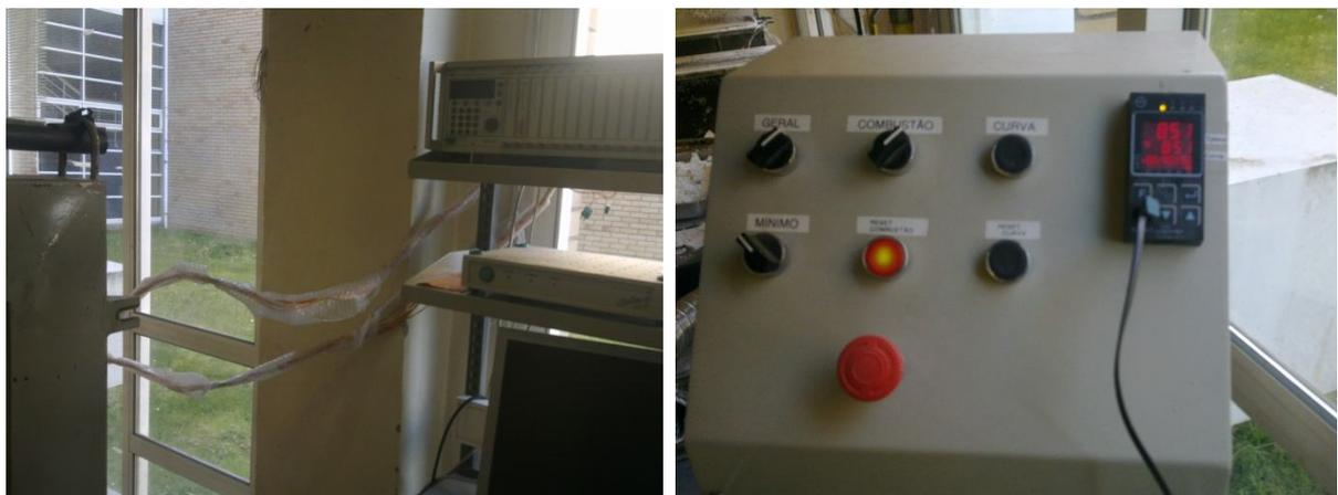
**Figure 4.9.** Câblage des thermocouples four- voies d'acquisition et pupitre avec voyant de température des gaz à l'intérieur du four
