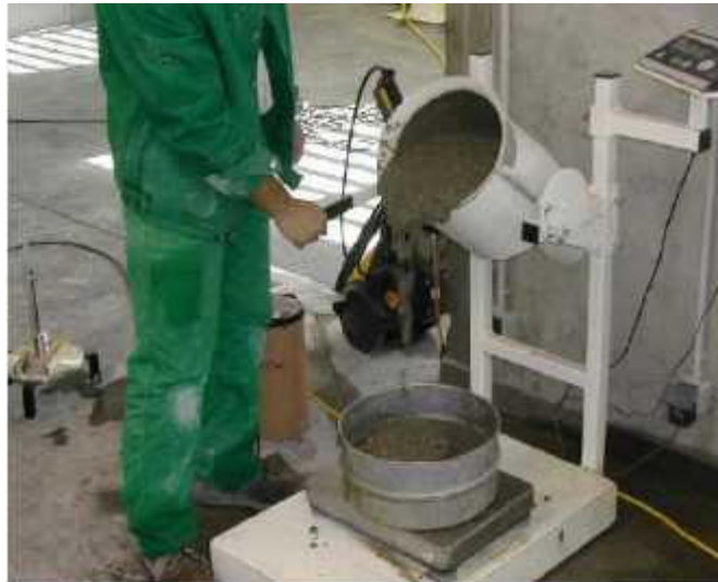
Figure 3.8 – Essai de stabilité au tamis.
