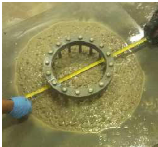
Figure 6.5 – Essai des anneaux japonais (J-ring test)
