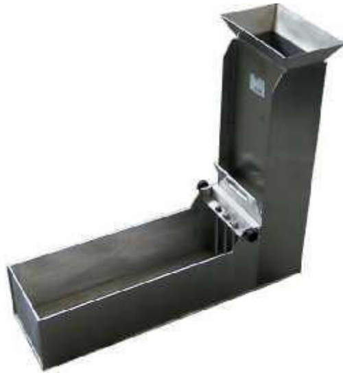
Figure 6.6 – Essai de la boîte en L (L-box test)
