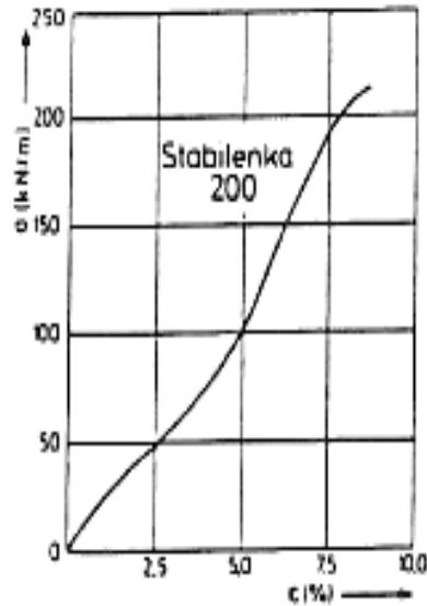
Figure 1.33 : Courbe effort de traction/déformation du géosynthétique Stablenka 200
