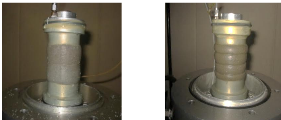
Figure III.10 : Photos après essais des échantillons de sable renforcé
