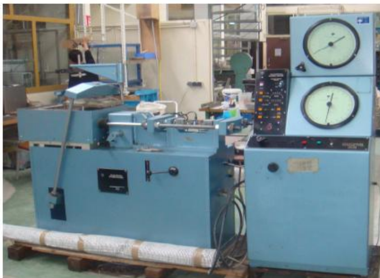
Figure IV.5 : Appareil de cisaillement de grandes dimensions (Laboratoire 3SR de Grenoble)
