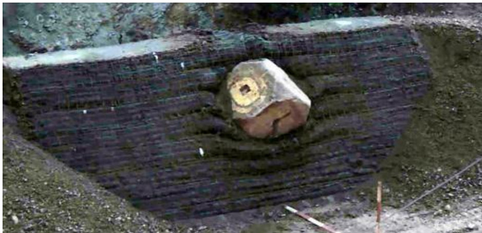
Figure V.37 : Aperçu du remblai renforcé après l'essai (OGG 04, PEI 07)
