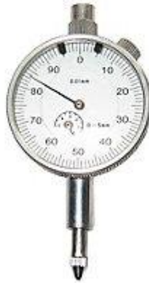
Figure 3.19 : Comparteur d'exactitude inférieure ou égale à 0,001 mm.
