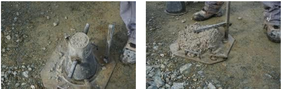
Figure 3.11 : Réalisation de l'essai d'affaissement du cône d'Abrams.
