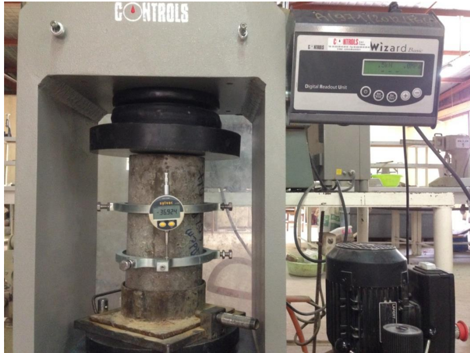
Figure 3.17 : Dispositif pour le calcul du module d'élasticité.
