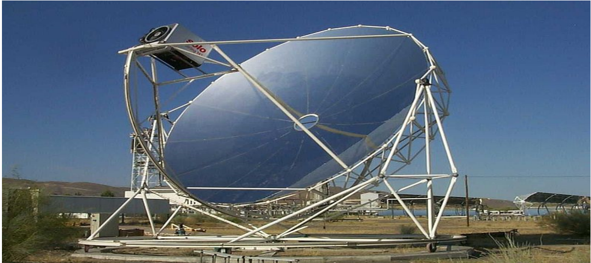
Figure 4 : Moteur stirling solaire à Almeria en Espagne (Plataforma Solar)
