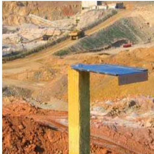
Figure 2.7 : Plaque métallique fixée sur un support à 1,50 m du sol [52]
