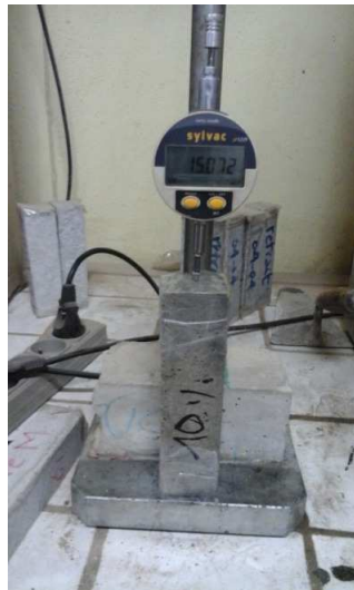
Figure 5.2 : Mesure du retrait par le Rétractomètre
