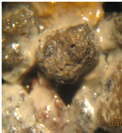
e/ Lc.d4 immobilisée sur pouzzolane de granulométrie de 4 mm
