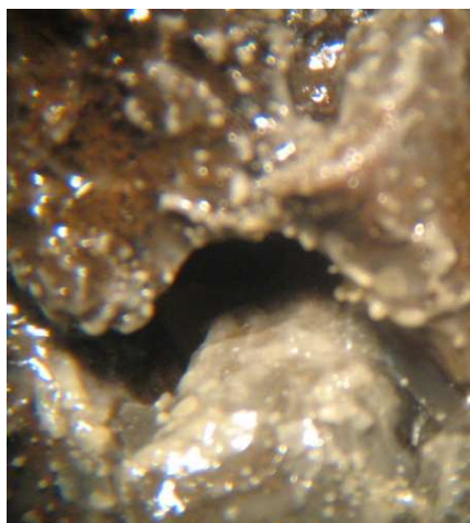
b/ Lc.d4 immobilisée sur pouzzolane de granulométrie de 6.25 mm
