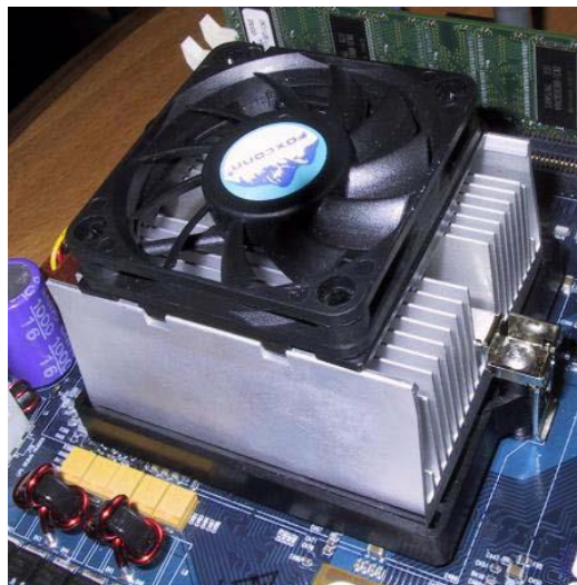
Figure I.20: Assemblage dissipateur de chaleur/ventilateur (Ventirad)
