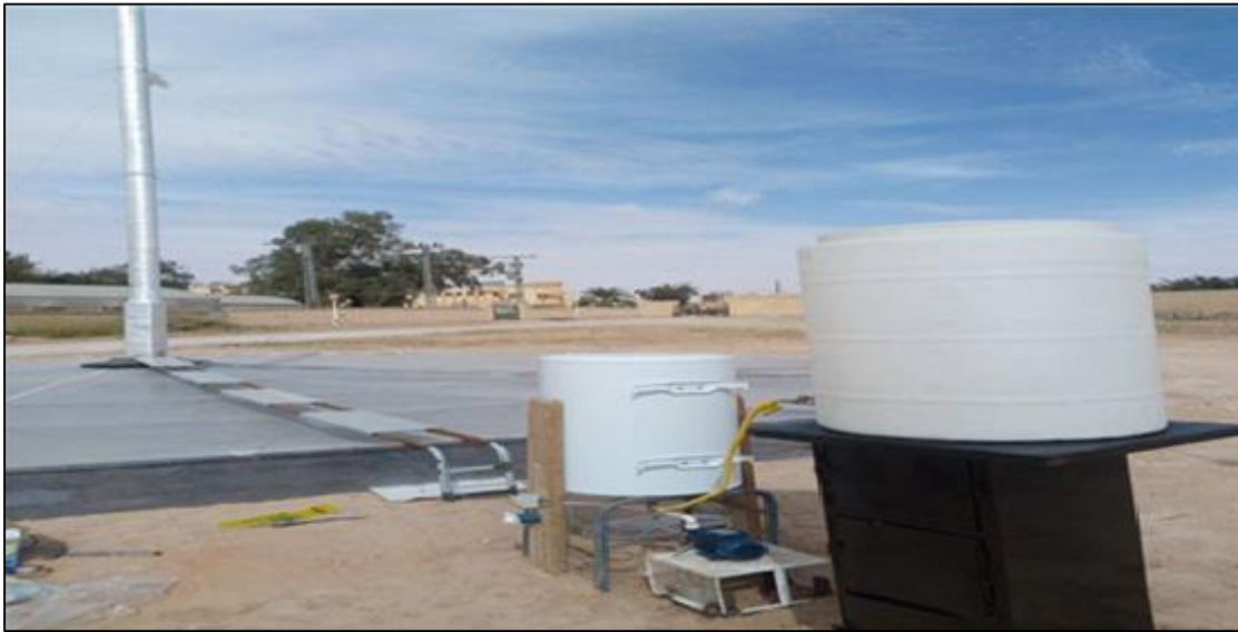
Fig. III.22 : Réchauffeur d'eau électrique intégré avec le prototype CCS
