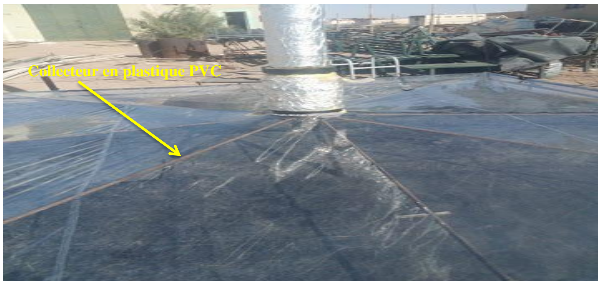
Fig. III.3 : Collecteur en pastique PVC utilisé
