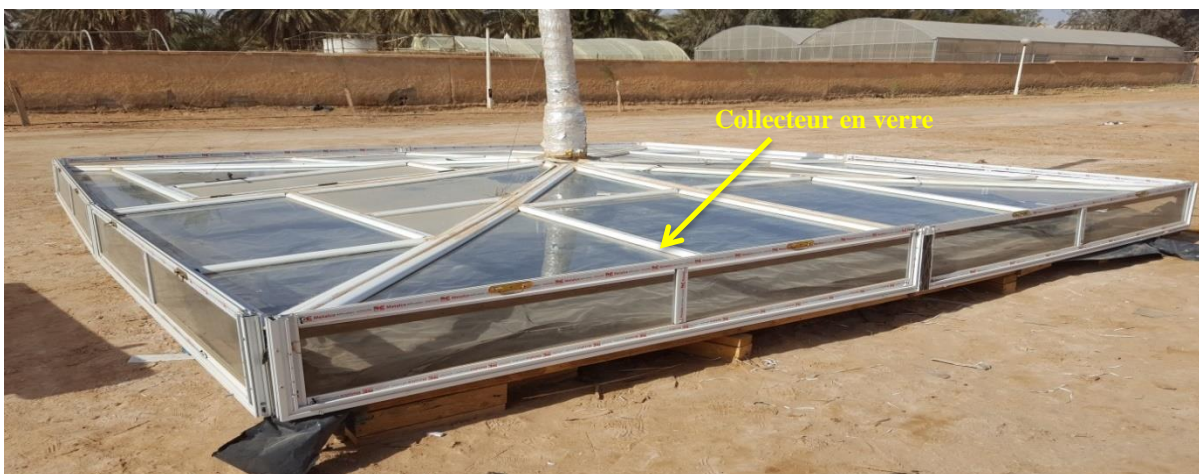
Fig. III.7 : Le collecteur carré (5x5 m) avec couverture en verre
