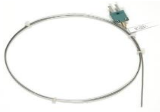
Fig. III.25 : Thermocouple type K utilisé
