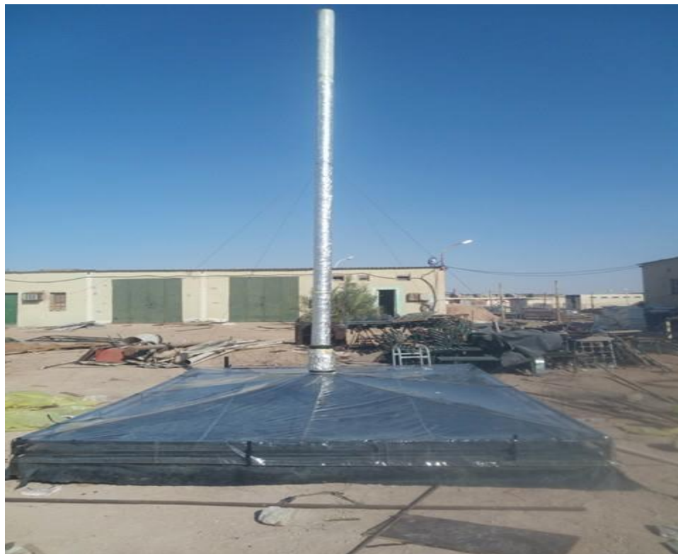
Fig. III.5 : Vue générale du prototype cheminée solaire n°1
