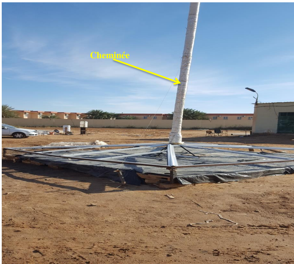
Fig. III.9 : La cheminée de prototype n°2
