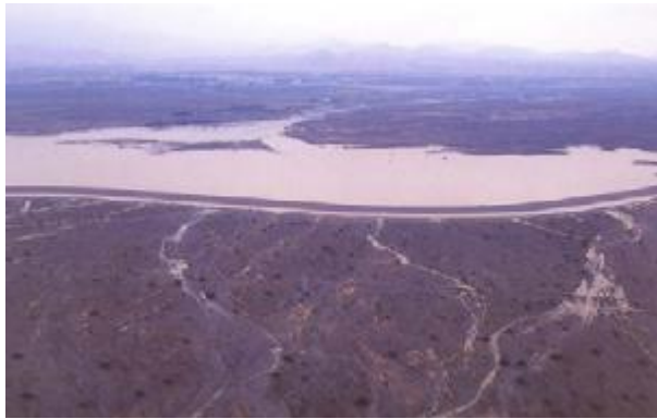
Figure 2.10: Inondation à partir du barrage Al Khoud (Sultanat d'Oman) pour la recharge artificielle de la nappe alluviale [Haimerl, 2004].
