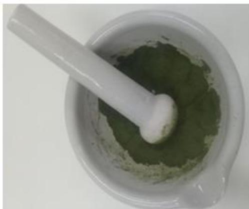
**Figure IV.19:** Broyage de la biomasse sèche.
