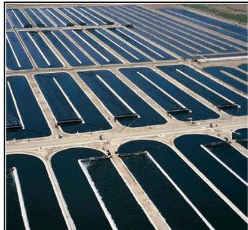
**Figure II.3 :** Photographie aérienne des bassins de type raceway [54]
