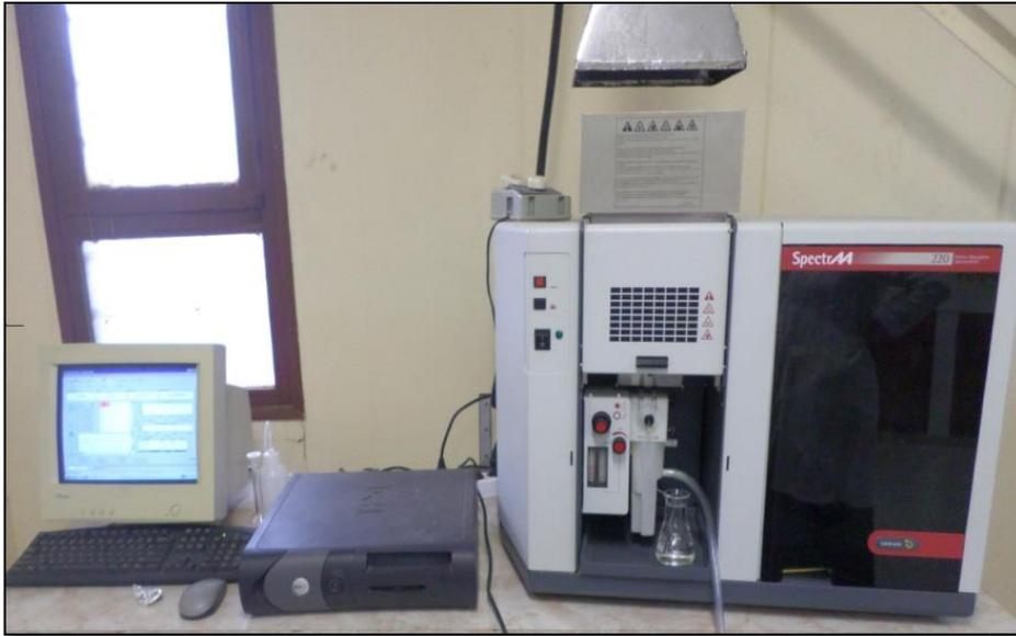
**Figure** : Spectrophotométrie d'absorption atomique.
