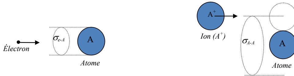
Fig. I-3: Représentation de la section efficace dans le cas où l'atome est considéré comme sphère et sans tenir compte du potentiel d'interaction
