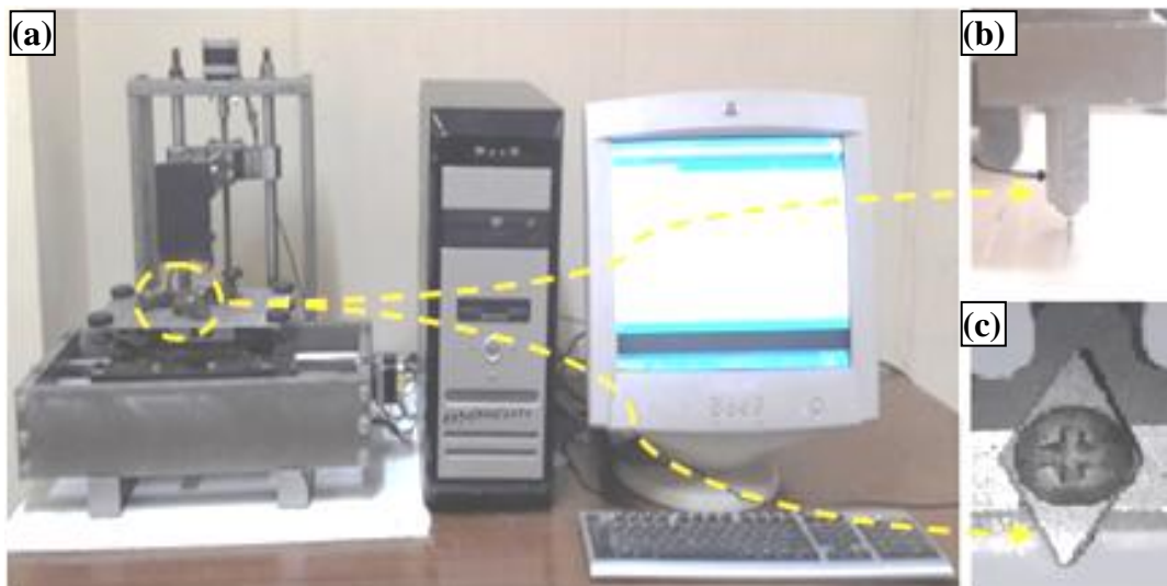
Figure 2-18 Banc d'essai de rayage réalisé et pointes utilisées, (a) vue générale du banc, (b) Pointe Conique et (c) Plaquette en carbure métallique.
