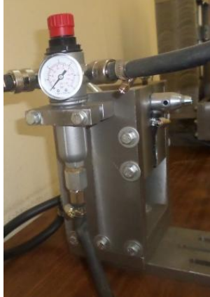
Figure 3 Porte pistolet de sablage et régulateur de pression d'air utilisés
