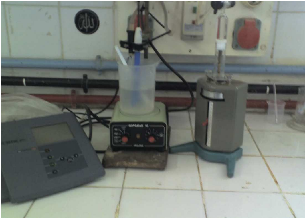
Fig 16. pH-MÈTRE avec la burette de dosage (W.T.W)
