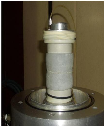
**Fig. 5.22. Allure de l'échantillon renforcé par une nappe de géotextile après cisaillement**
