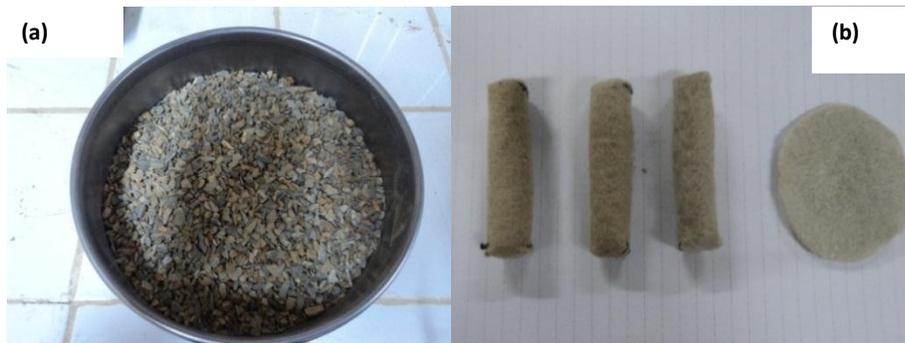
**Fig. 5.8. Sable utilisé pour restituer le ballast (a) et colonnes confectionnées (b)**
