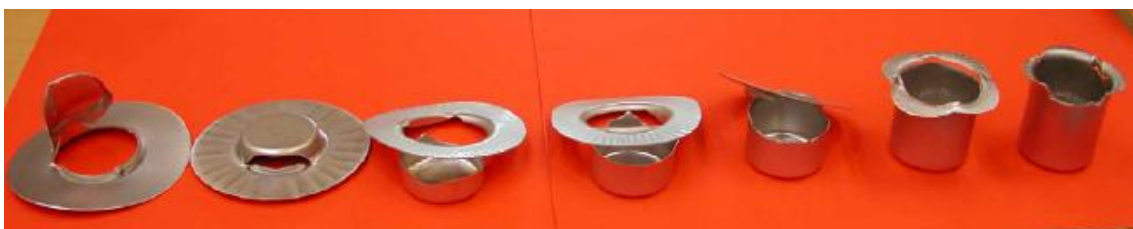
Figure 1-21 : Rupture en hydroformage de tôles [26].
