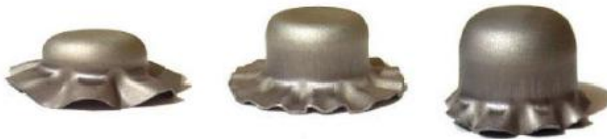
Figure 1-23 : Phénomènes de plissement en hydroformage de tôles [27].
