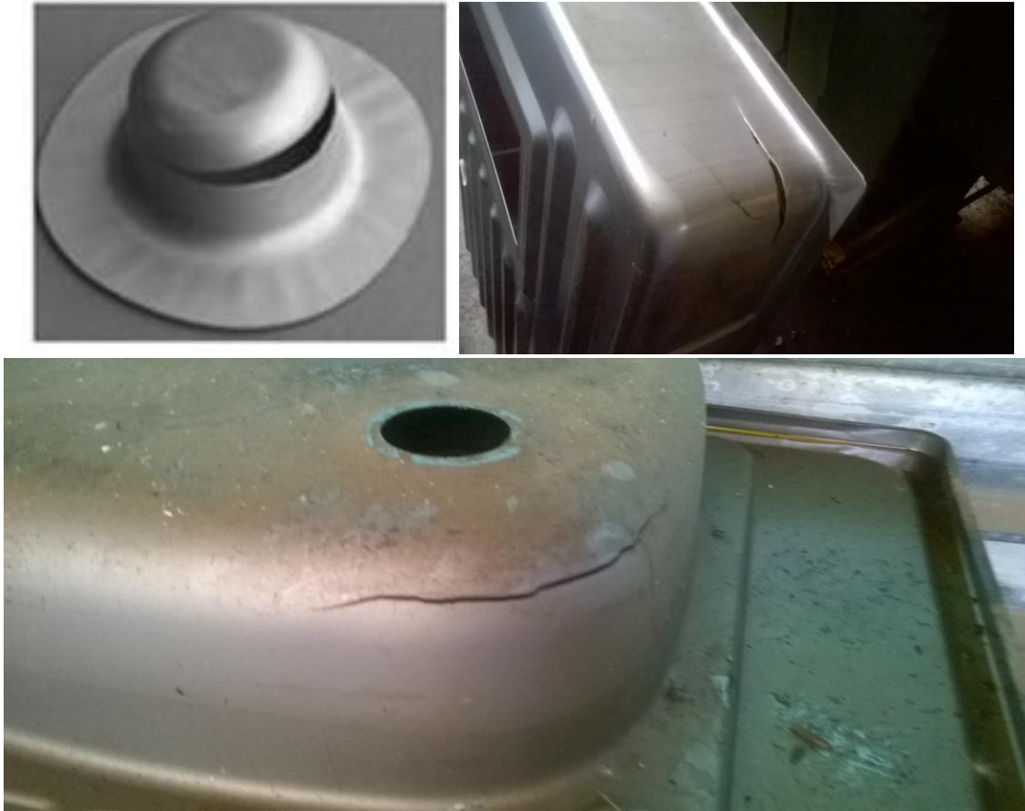
Figure 1-31 : Quelques cas de déformation de pièces où la limite de formabilité a été dépassée.
