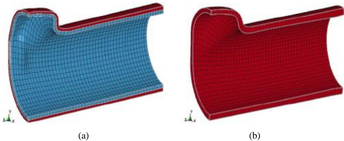
Figure 1-7 : Simulation numérique de l'hydroformage de tube : a- hydroformage de tubes à double couche. b- hydroformage de tubes à une couche [9].
