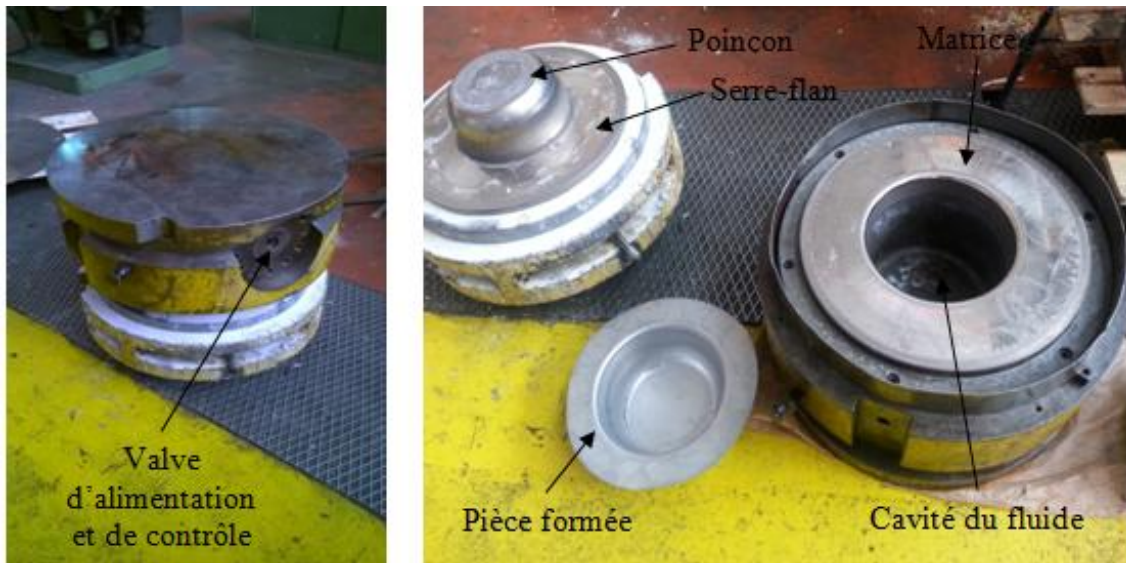
Figure 2-1 : Outils de formage hydromécanique, BCR-unité ORFEE.
