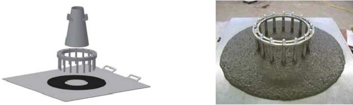
**Figure 1.7:** A gauche J-Ring + cône d'Abrams et à droite essai J-Ring.
