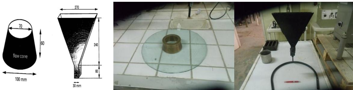
**Figure 1.14:** Cône pour mesurer l'étalement des mortiers et entonnoir pour mesurer le temps d'écoulement des mortiers (Ouchi 1997).
