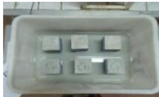
d) essai d'absorption
