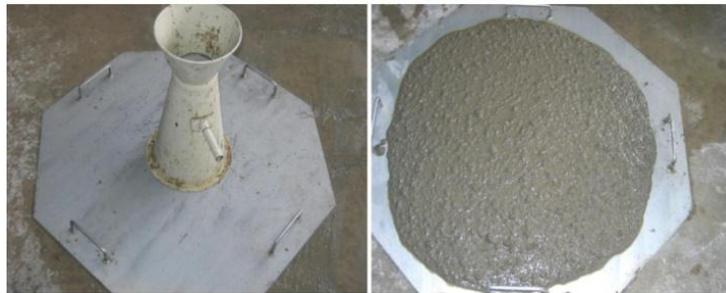
**Figure 1.6:** Essai d'étalement au cône d'Abrams.
