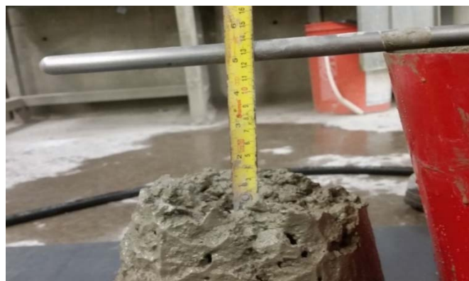
Figure 5.3 – Mesure d'ouvrabilité avec le cône d'Abrams.
