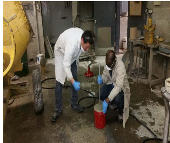
Figure 5.4 – Mesure la teneur en Air et la masse volumique
