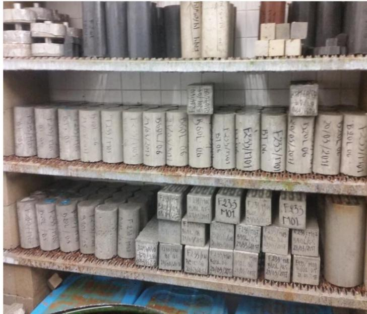
Figure 5.4 — Stockage des échantillons dans une chambre humide
