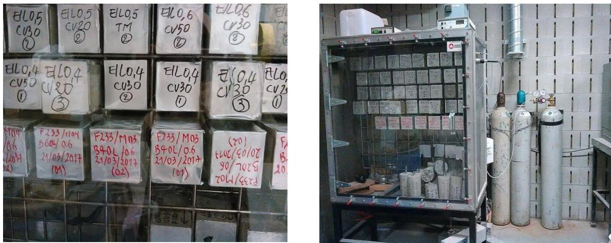
**Figure 5.5** — Stockage des prismes dans la chambre de carbonatation accélérée
