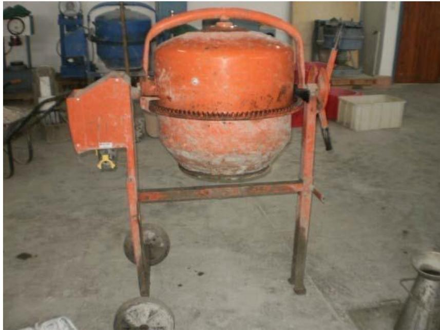
**Figure 5.2** — Malaxeur d'une capacité de 125l
