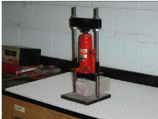
Figure 5 6 — Equipement utilisé pour obtenir du béton fracture frais
