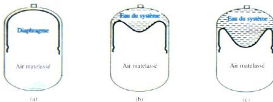
Figure III.5 : Principe de fonctionnement du vase d'expansion [06].
