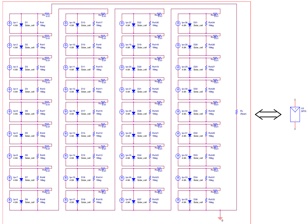
Figure II-28 : Le modèle du panneau SP75 PV à base de la cellule proposée et son block hiérarchique.
