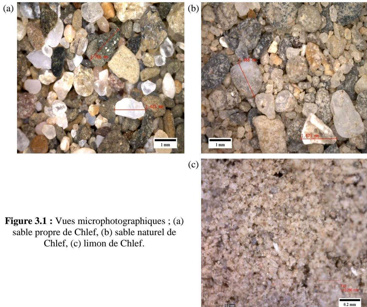
**Figure 3.1 :** Vues microphotographiques ; (a) sable propre de Chlef, (b) sable naturel de Chlef, (c) limon de Chlef.
