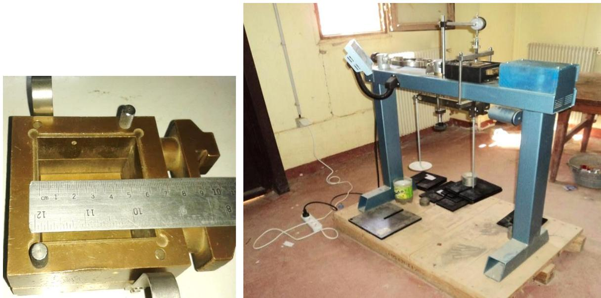
Figure 3.5 : Boite de cisaillement utilisée (laboratoire de MDS de l'université de Chlef).
