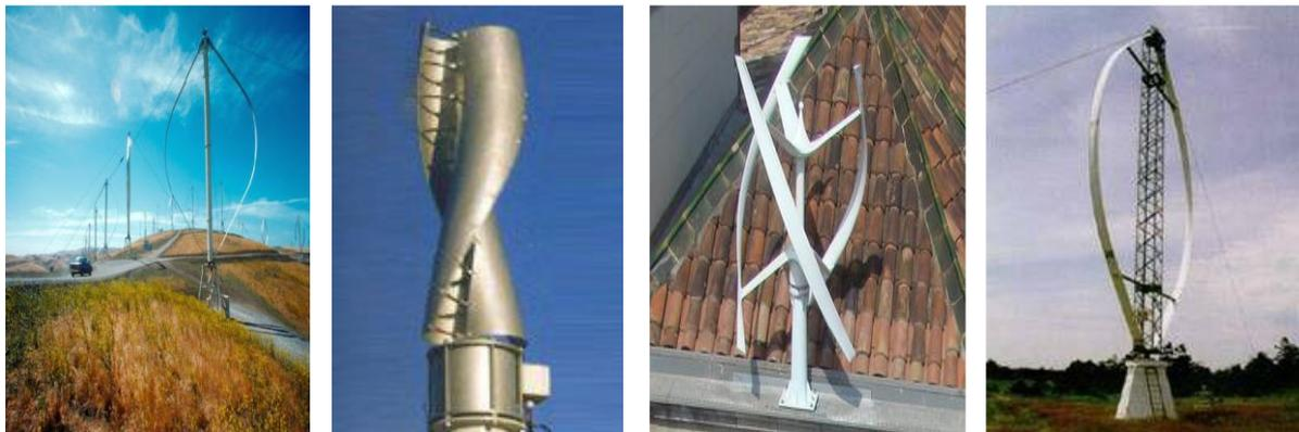
Figure I.9 L'aérogénérateur à axe vertical.
