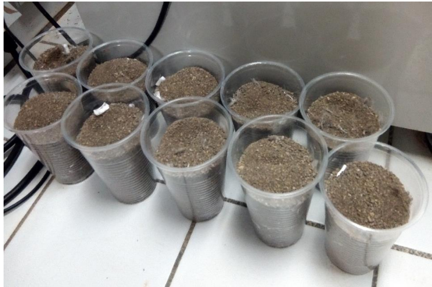
Figure 2.6 Préparation des échantillons par couche : division en 10 couches.
