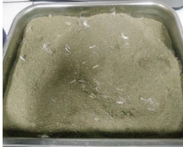
Fig. 2.21 Préparation des échantillons de sable renforcé par des fibres de polypropylène.
