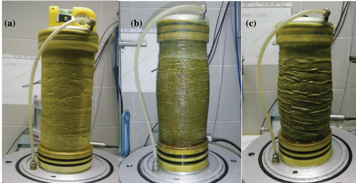
Figure 3.11 Evolution de la forme des échantillons renforcés et non renforcés avant et après cisaillement. (a) avant cisaillement (b) sable non renforcé après cisaillement (c) sable renforcé après cisaillement.
