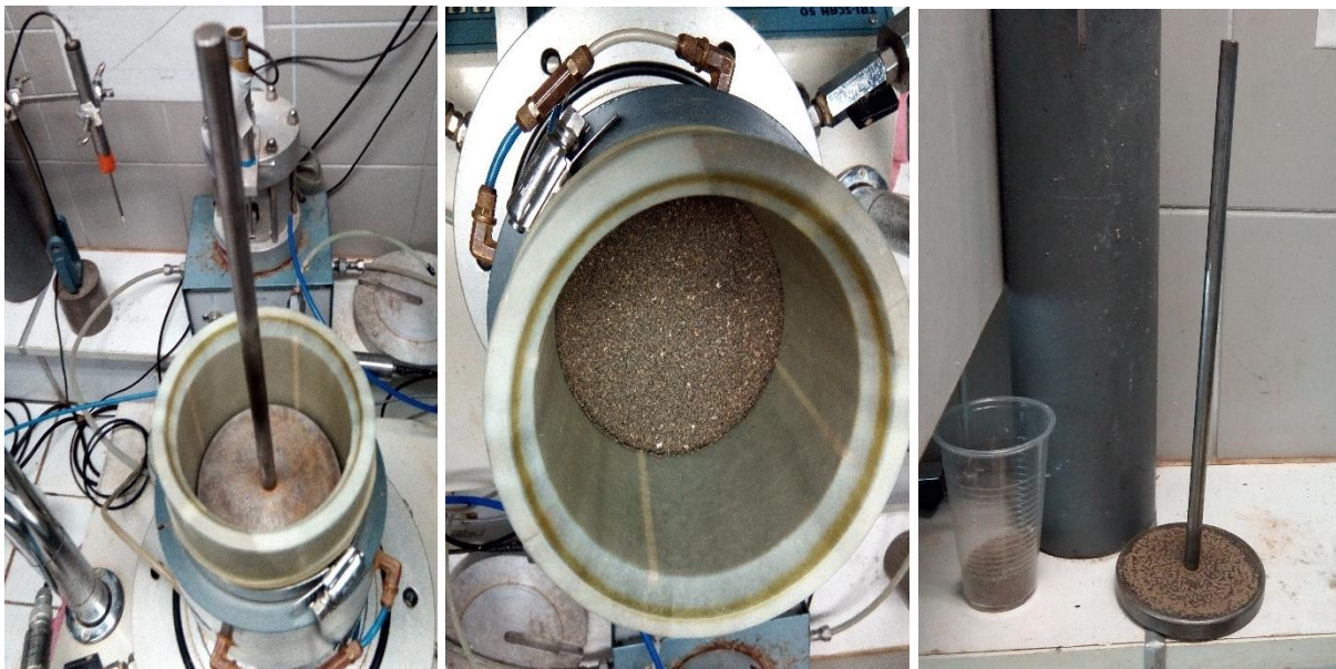
Figure 2.7 compactage de l'échantillon.
