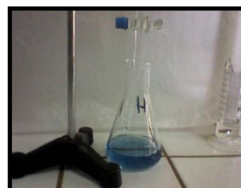
Dosage de l'azote par minéralisation (01), et distillation par BUCHI (02).
