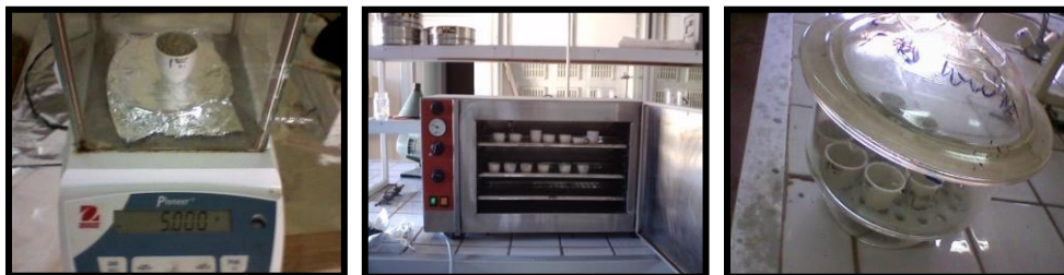
1. Première pesée 2. Les creusets dans l'étuve 3. Refroidissement dans le dessiccateur.
