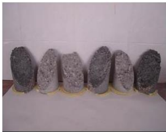
Rupture à l'interface
