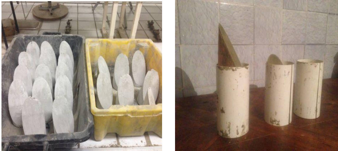
Figure 4.10 – Préparation des demi-cylindres pour l'essai de cisaillement oblique.
