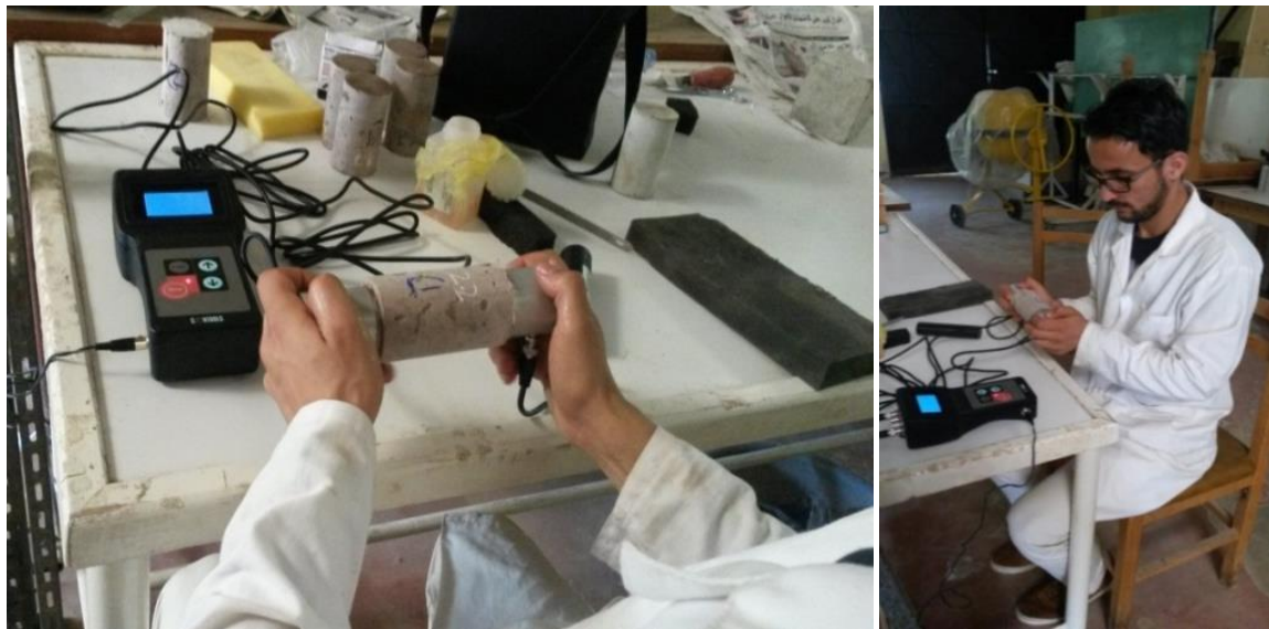
Figure 4.6 – Mesure de la vitesse du son dans une éprouvette en CCHD.
