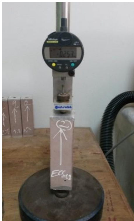
Figure 4.7 – Schéma du dispositif de mesure du retrait.
