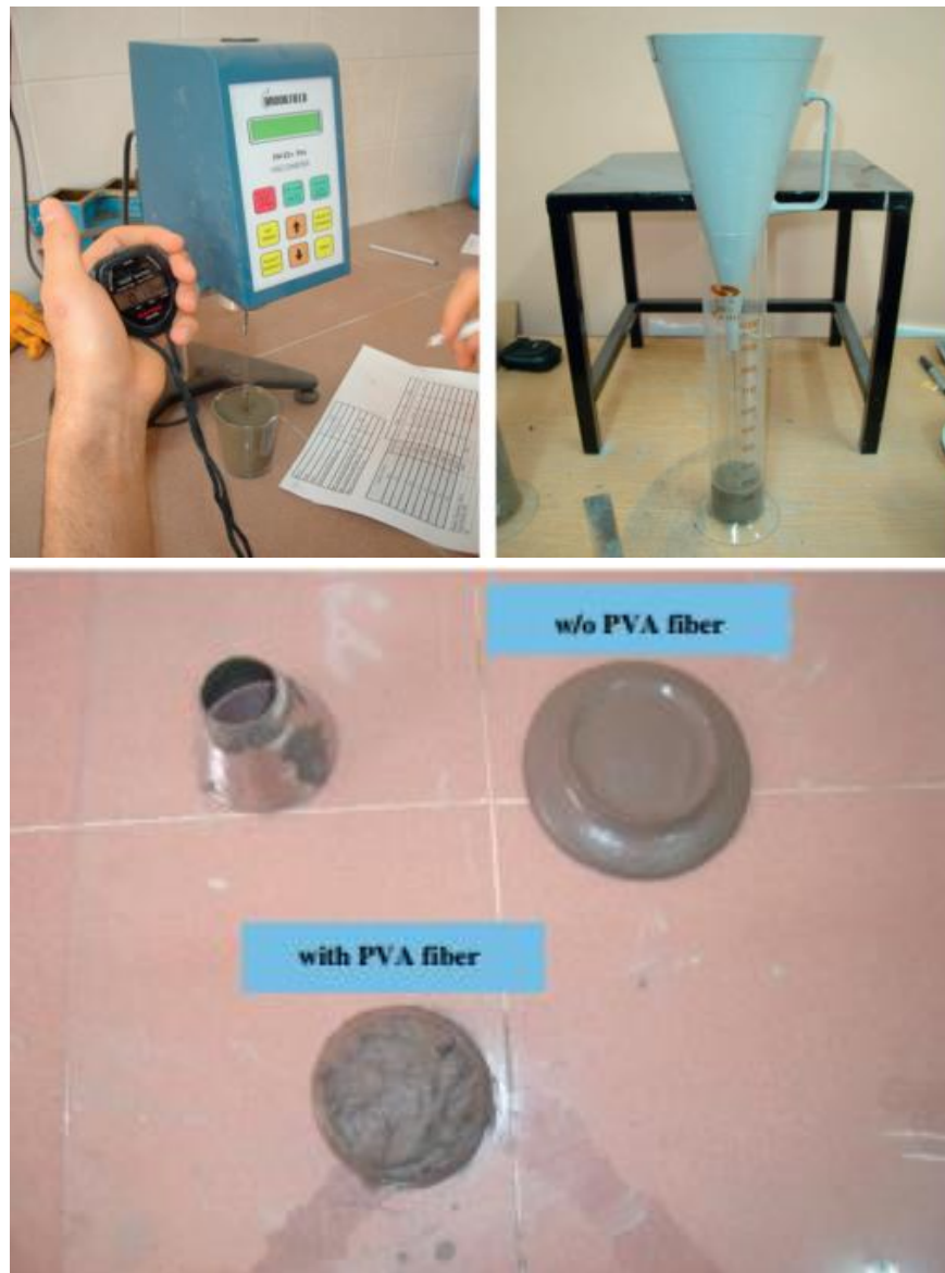
Figure 3.6 – Ouvrabilité du mélange CCHD avec fibre et sans fibre ( Şahmaran et al., 2013b ).
