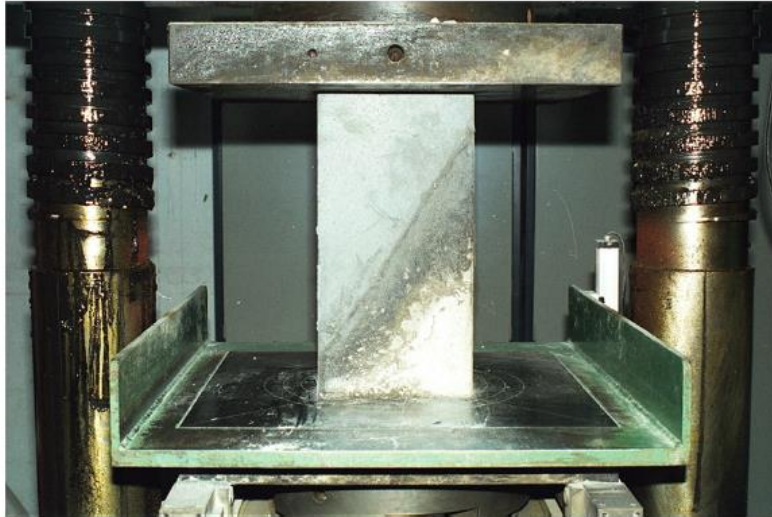
Figure 2.14 – Essai de la résistance d’adhérence au cisaillement oblique (Santos, 2007).
