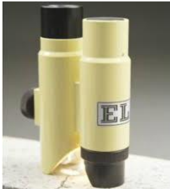
Figure 4.5 – Fissuromètres pour mesurer l'ouverture des fissures.
