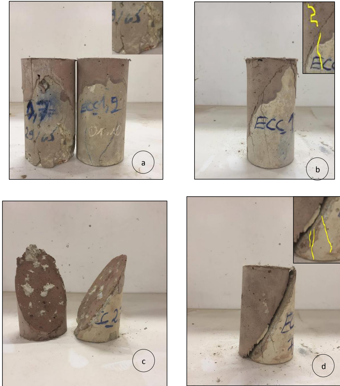
Figure 5.9 – Modes de rupture des éprouvettes composées CCHD/Substrat : a et b Compatible ; c et d Incompatible.
