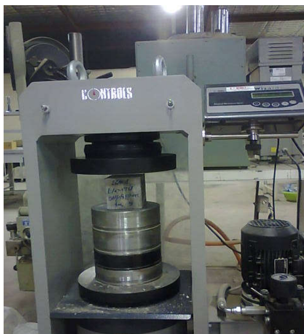
Figure 4-1 : Dispositif de l'essai de compression.
