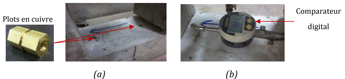
Figure 7-6 : Avant et après la mesure du fluage en compression.
