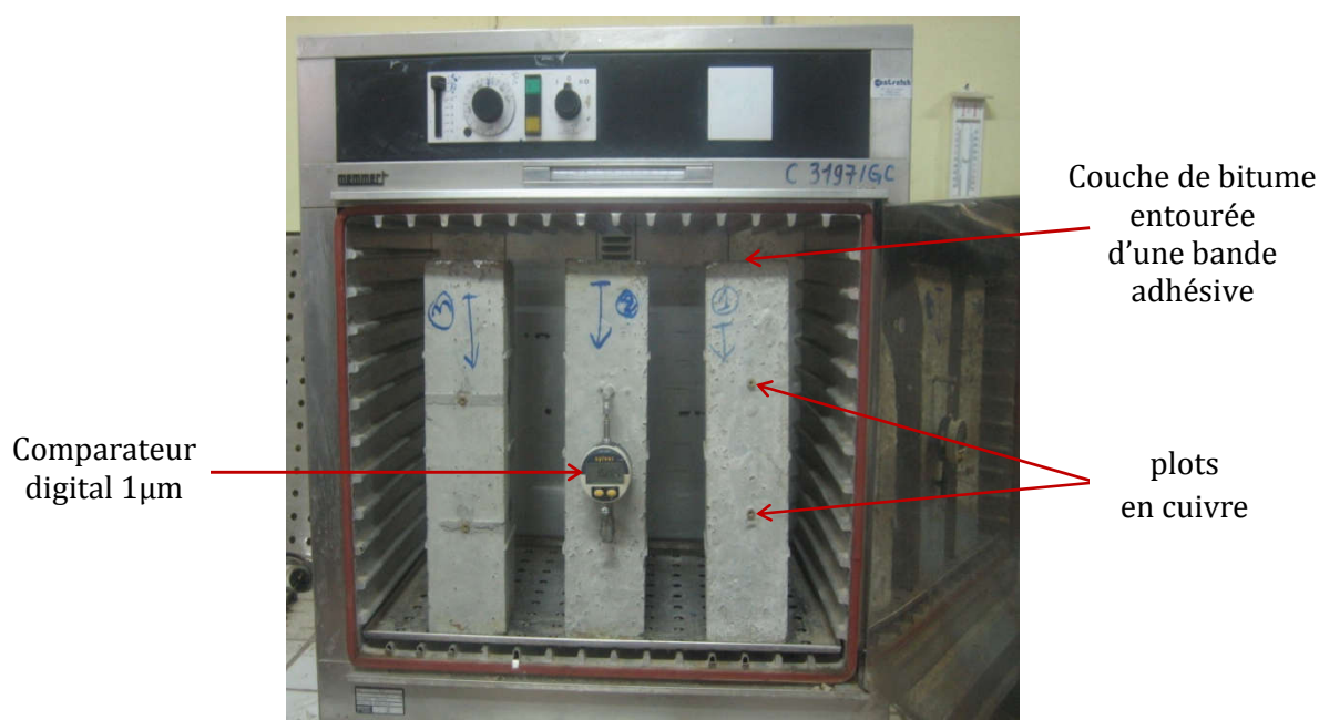
Figure 5-1: Eprouvettes dans l'étuve à vapeur.
