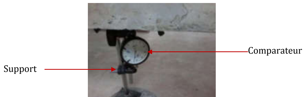
Figure 7-7 : Mesure de la flèche.
