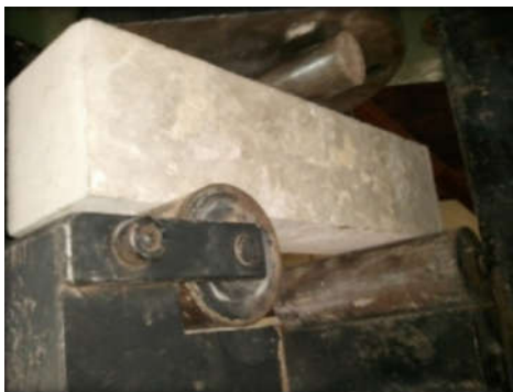
Figure 4-2 : Dispositif de l'essai de traction par flexion.
