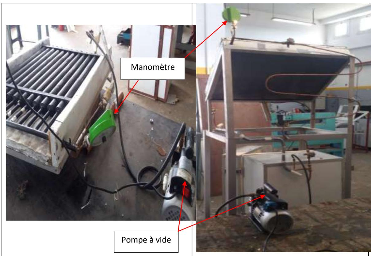
**Figure III.11.** Vérification de l'étanchéité des éléments du système
