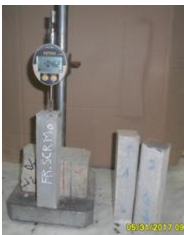
Figure 4.14 – Rétractomètre pour la mesure du retrait des MAPF s .
