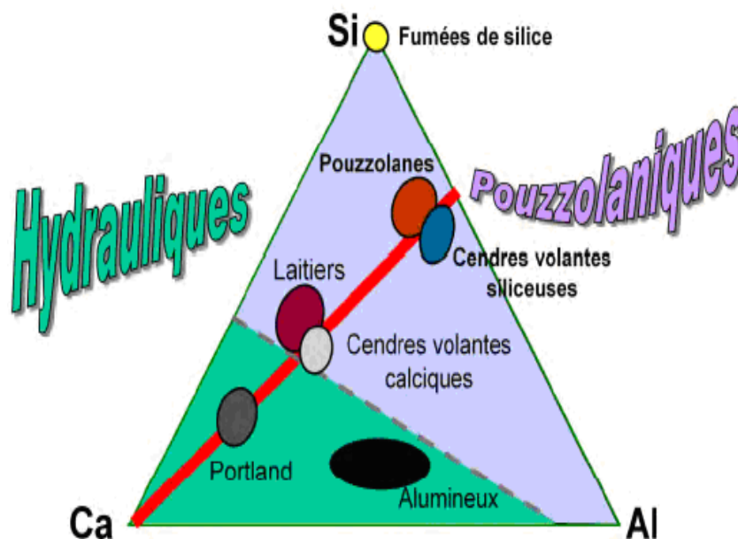
Figure 2.3 – Principaux constituants du ciment.
