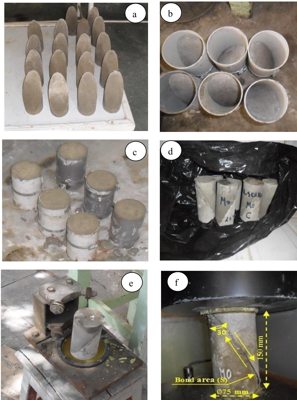
Figure 4.16 – Préparation des composites MAP-Substrat et essai d'adhésion (slant shear test): a) saturation des substrats ; b) introduction des substrats dans les moules ; c) coulage des mortiers de réparation MAP ; d) cure des composites e) surfacage des composites ; f) essai de compression.
