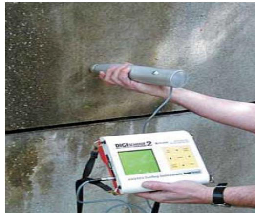
Mesures sclérométrique avec enregistreur ( Divet et al. 2005 ).
