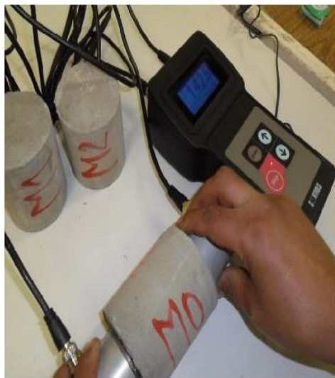
Figure 4.13 – Essai du module d'élasticité dynamique E_D des MAPF s .
