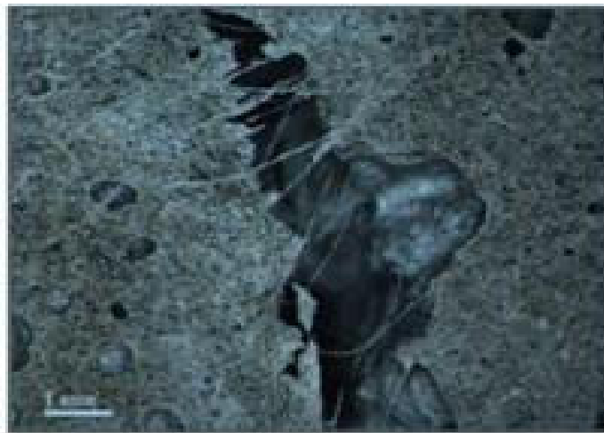
Figure 2.12 – Photo MEB montrant le pontage des fissures par les fibres de polypropylène (Mallat et al. 2011).
