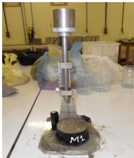
Figure 4.8 – Appareil de Vicat pour la mesure du temps de prise des MAPFs.
