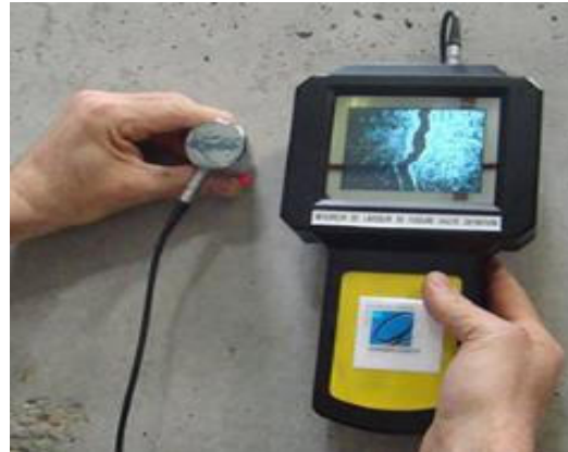
Mesureur de largeur de fissures électronique ( Ginger-cebtp )
