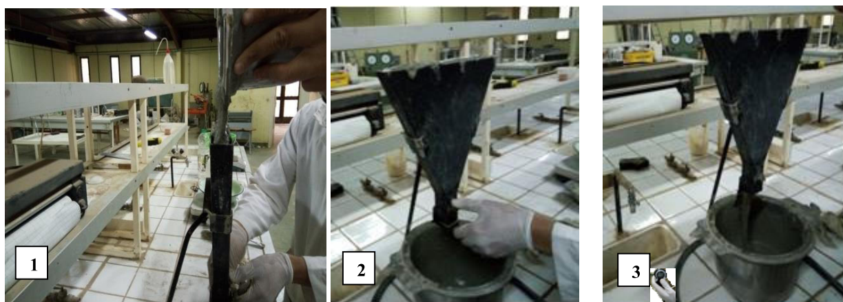
Figure 4.6 – Temps d'écoulement des mortiers de réparation mesuré au mini V-funnel.
