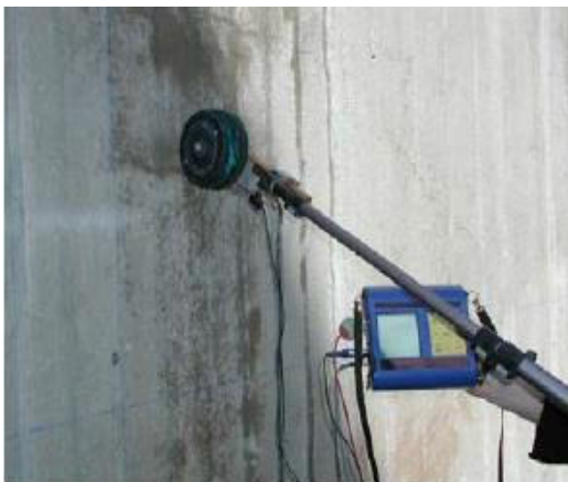
Roue électrode pour estimer la corrosion ( AFGC 2003 ).
