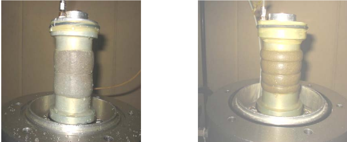
Figure 3.4: Mode de déformation des échantillons renforcés par une et trois couches des géotextiles.
