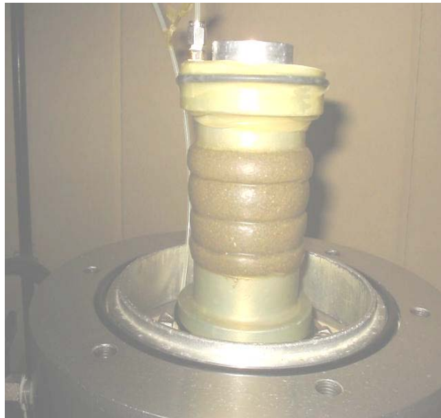
Figure 4.36: Photographie typique du sol lâche renforcé par trois nappes de géotextile ( \sigma'_c = 100 kPa)
