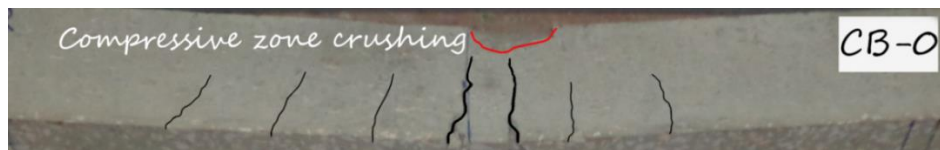
Figure 5.2. Mode de rupture ductile de la poutre témoin.
