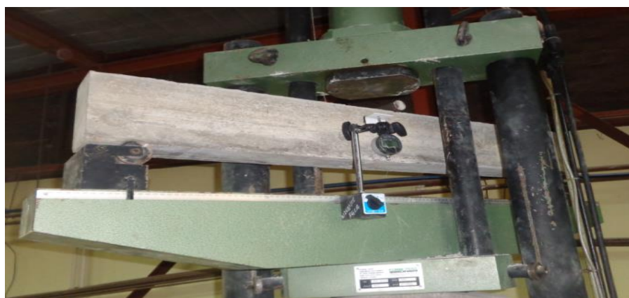
Figure 4.10. Dispositif expérimental des essais de poutres
