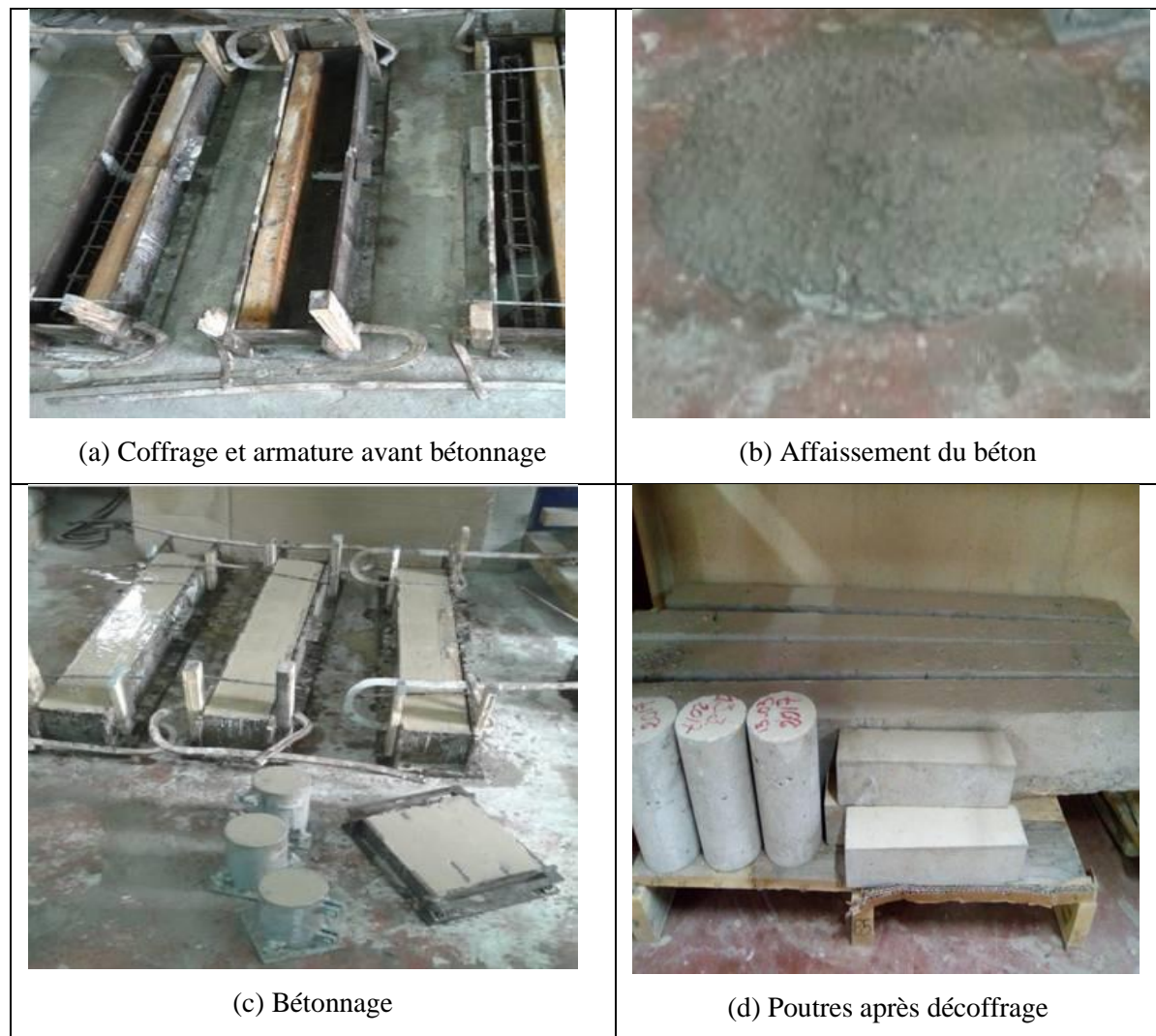
Figure 4.7. Fabrication des spécimens d'épreuve et les éprouvettes de contrôle.
