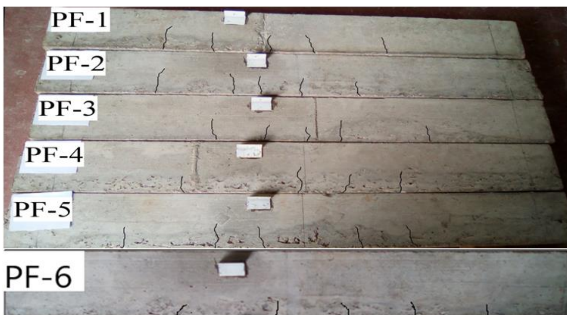
Figure 4.9. Pré fissuration des spécimens d'épreuve.
