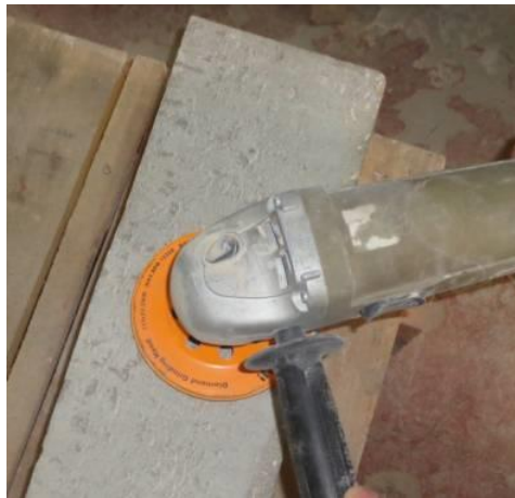
Figure 4.8. Préparation des surfaces des spécimens d'épreuve.
