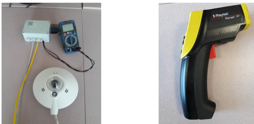
Fig. III.3. A droite le pyranomètre, à gauche le thermomètre IR
