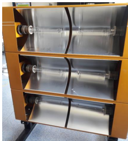
Fig. III.2. Source d'irradiation artificielle DELTALB 6 kW
