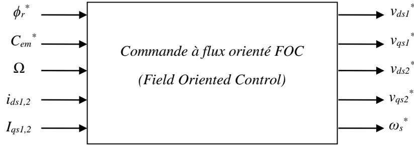
Figure III-11 : Schéma de principe de la commande à flux orienté (FOC)
