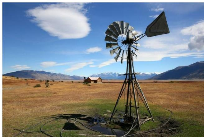
Figure I-2 : Eolien de pompage.
