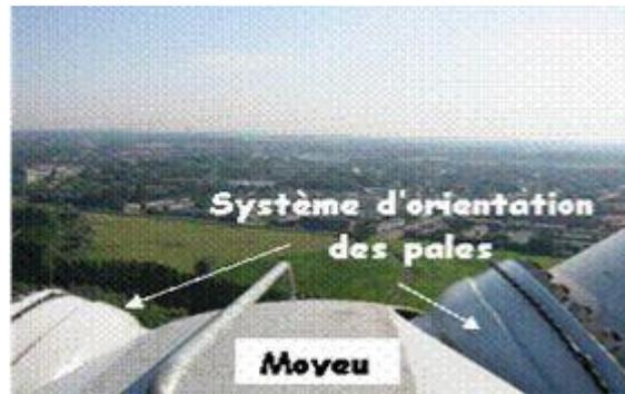
Figure II-3 : Système d'orientation des pales.
