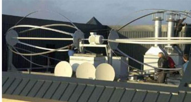
Figure I-7 : Éolienne Darrieus horizontal.
