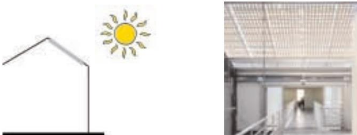
Fig3.7 Verrière intégrée (type C2.2) [23]
