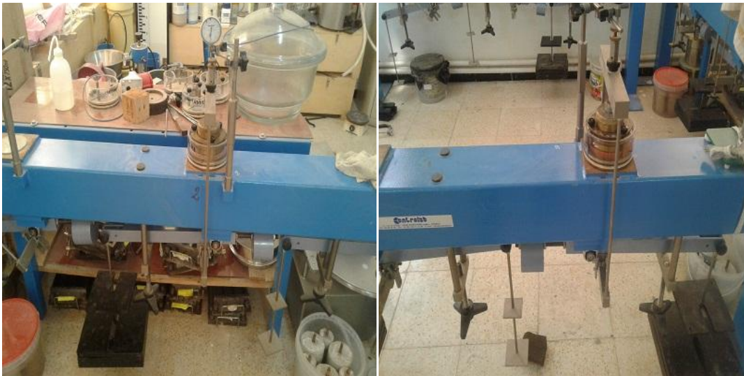
Figure II. 2: Appareil œdométrique utilisé dans cette étude
