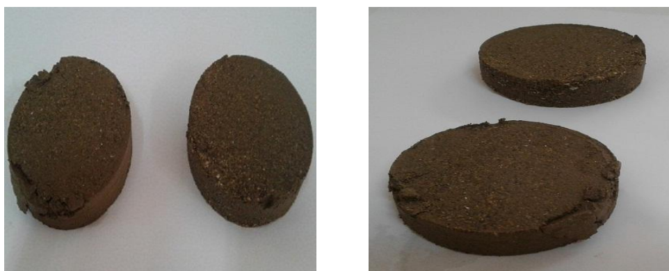
Figure IV. 2: Les échantillons après un essai oedométrique
