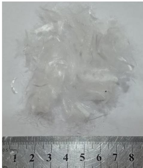
**Figure 3. 5:** Fibre de polypropylène utilisée dans cette étude.
