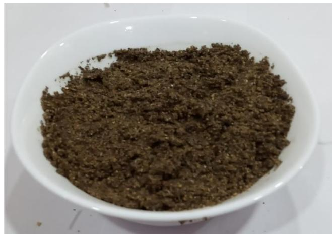
**Figure 3. 8:** Echantillon préparé du sable cimenté pour un essai triaxial.
