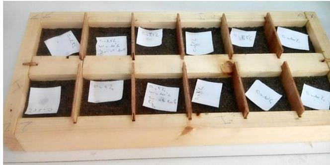
**Figure 3. 6:** Echantillon préparé du sable cimenté.
