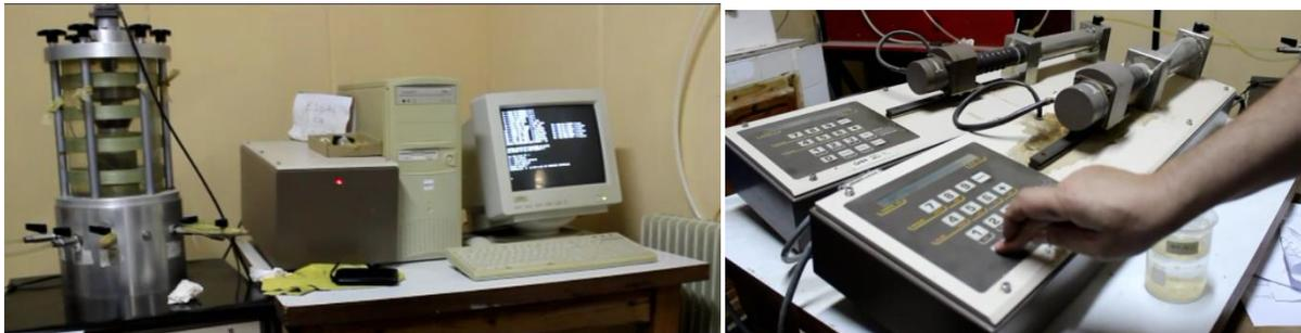
**Figure 3. 12** : Appareille triaxial.
