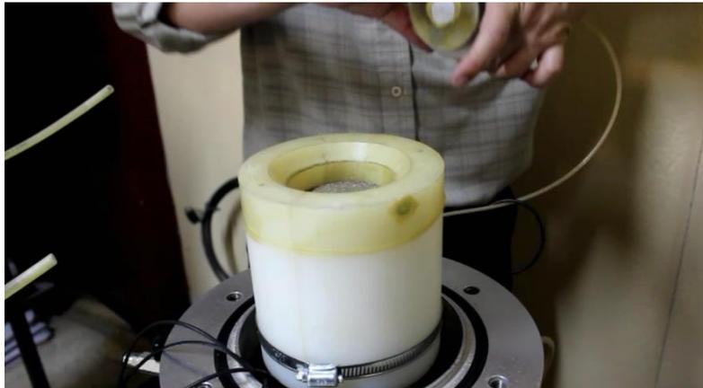
Figure 3. 9 : Mise en place de la membrane et du moule
