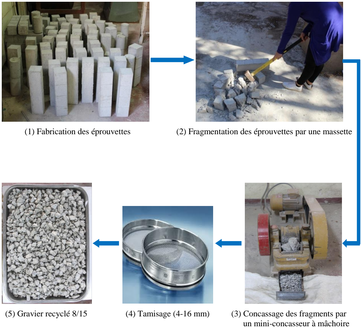
Figure 4. 1. Processus de production du gravier recyclé.
