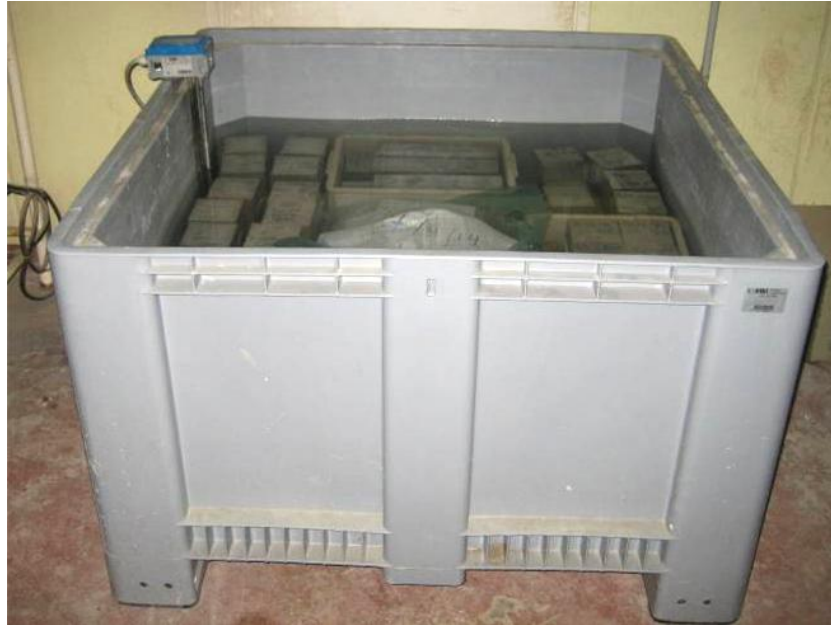
Figure 4. 9. Mode de conservation des éprouvettes.
