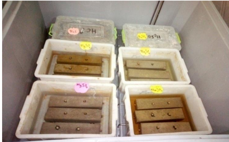
Figure 4. 22. Immersion des éprouvettes dans les solutions agressives.
