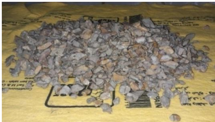
Figure 4. 5. Séchage de l'eau adsorbée des GR pré-saturés à l'aide d'un chiffon absorbant.
