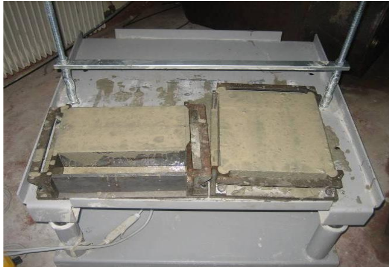
Figure 4. 8. Vibration des éprouvettes à l'aide d'une table vibrante
