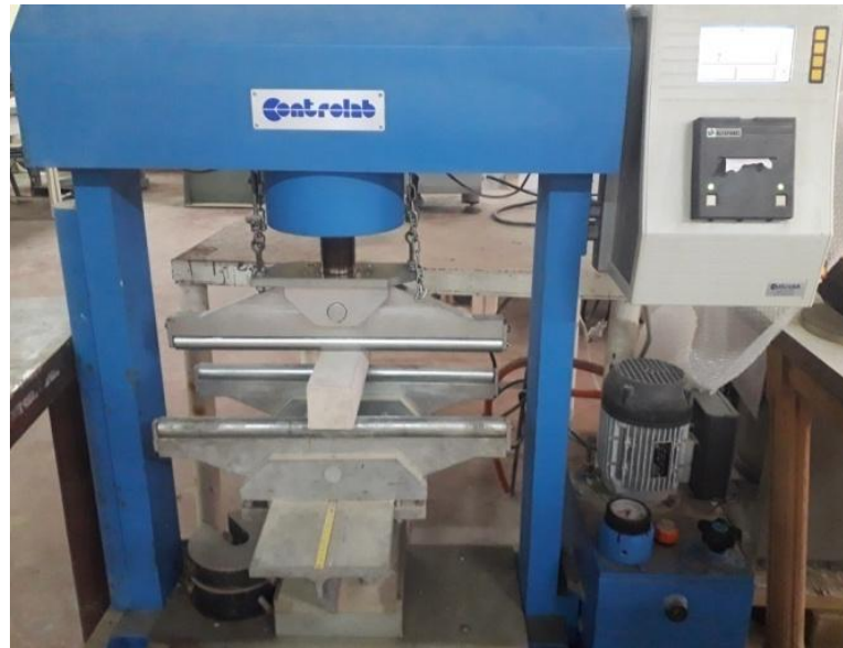
Figure 4. 11. Essai de traction par flexion trois points.
