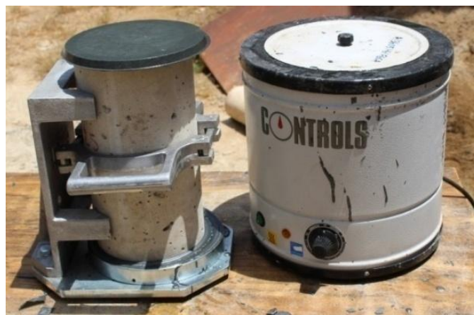
Figure 4. 13. Surfaçage au soufre des éprouvettes cylindriques
