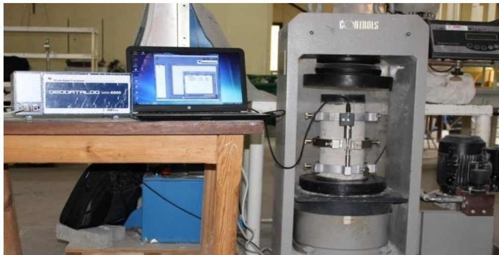
Figure 4. 12. Dispositif de mesure du module d'élasticité.
