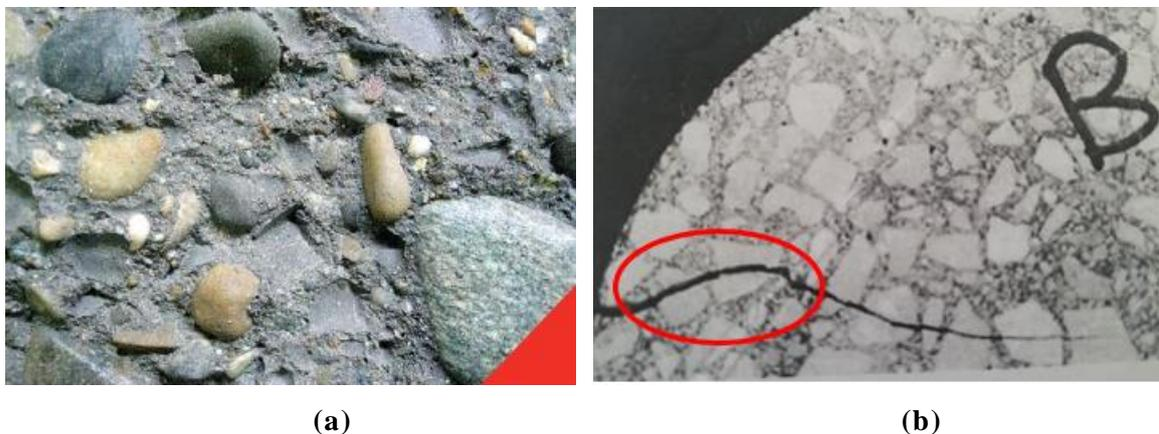
**Figure 1.9.** Surfaces de la fissure: (a) Béton ordinaire (surface rugueuse) ; (b) Béton à hautes performances (surface lisse) [33].
