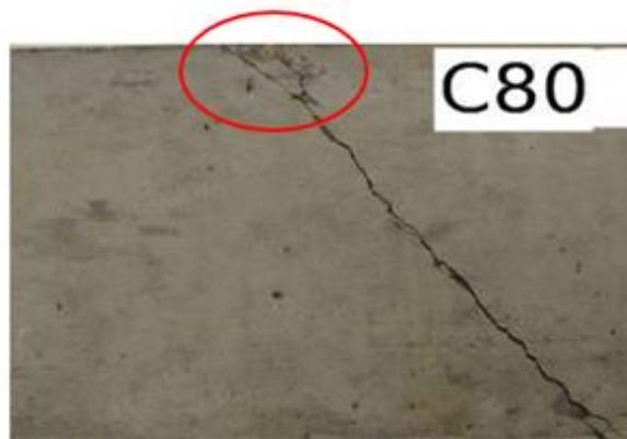
**Figure 2.6.** Rupture par compression diagonale de la poutre[33].
