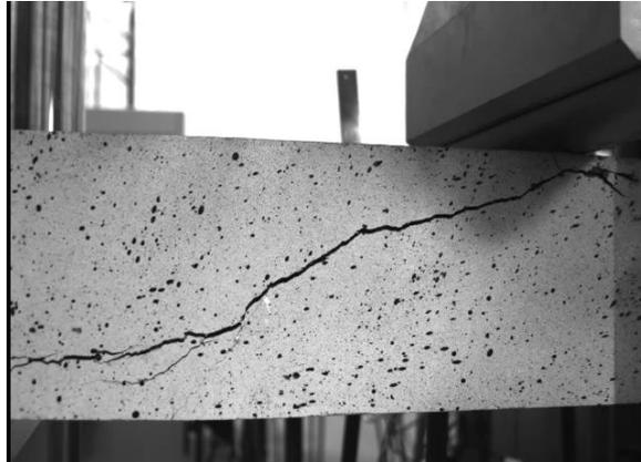
**Figure 2.5.** Rupture par traction diagonale [33].
