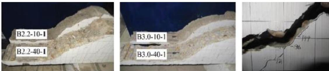
**Figure 1.10.** Observation visuelle de la surface de fissuration de la fissure de cisaillement [57].
