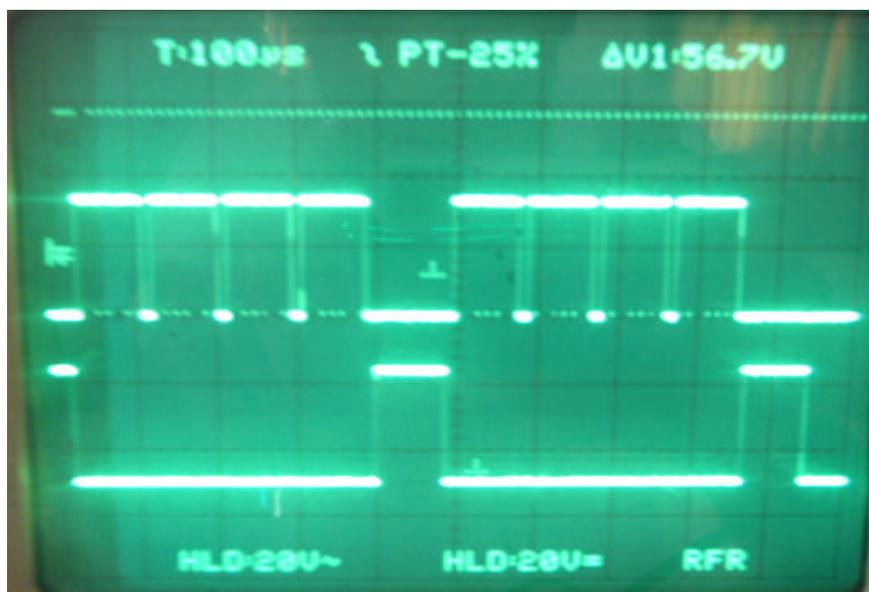
**Figure V. 1. Signaux de commande des interrupteurs Ta et Tb de la sortie.**
