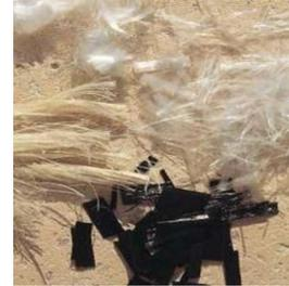
Ces fibres se présentent le plus souvent en faisceaux qui une fois introduits dans le matériau se séparent et se répartissent dans la masse du béton. Les fibres de polypropylène sont en général assez longues (30 à 60mm), légères et ne sont pas attaquées par le ciment, leur masse volumique est d'environ 0.9 kg/dm<sup>3</sup> et une bonne résistance à la traction qui peut atteindre 800 MPa avec une déformabilité élevée [12].
