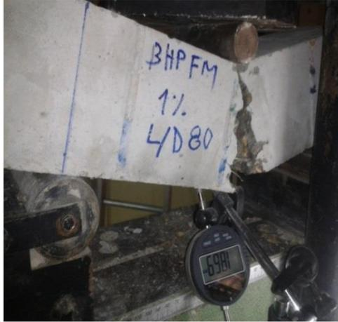
**Figure 3.18 :** Essai de déformabilité des mini-poutres pour un élanement des fibres de  $l/d=80$ .
