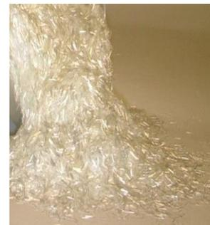
Elles sont disponibles dans le commerce sous forme de bobines (découpage à la demande) ou sous forme de morceaux prédécoupés de 3, 6, 12, et 50 mm de long. Elles sont regroupées en trois types ; la fibre de verre classique (silice, soude, chaux), la fibre de verre au zirconium et les fibres de verre au borosilicate. Plusieurs types de compositions verrières sont utilisés comme matières premières, en fonction de l'usage spécifique qu'il sera fait de la fibre [14, 15].
