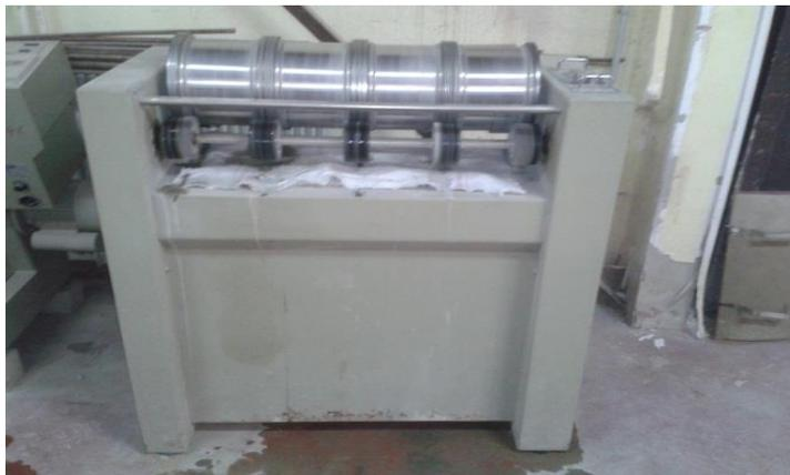
**Figure 3.20 :** Micro-Duval utilisé pour l'essai d'abrasion.
