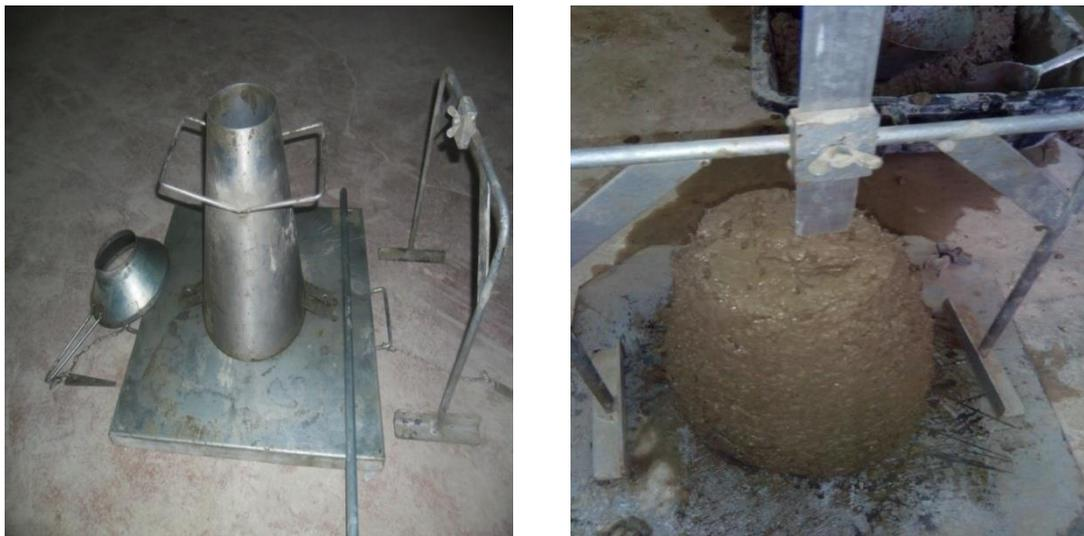
**Figure 3.11** : Mesure de l'affaissement au cône d'Abrams
