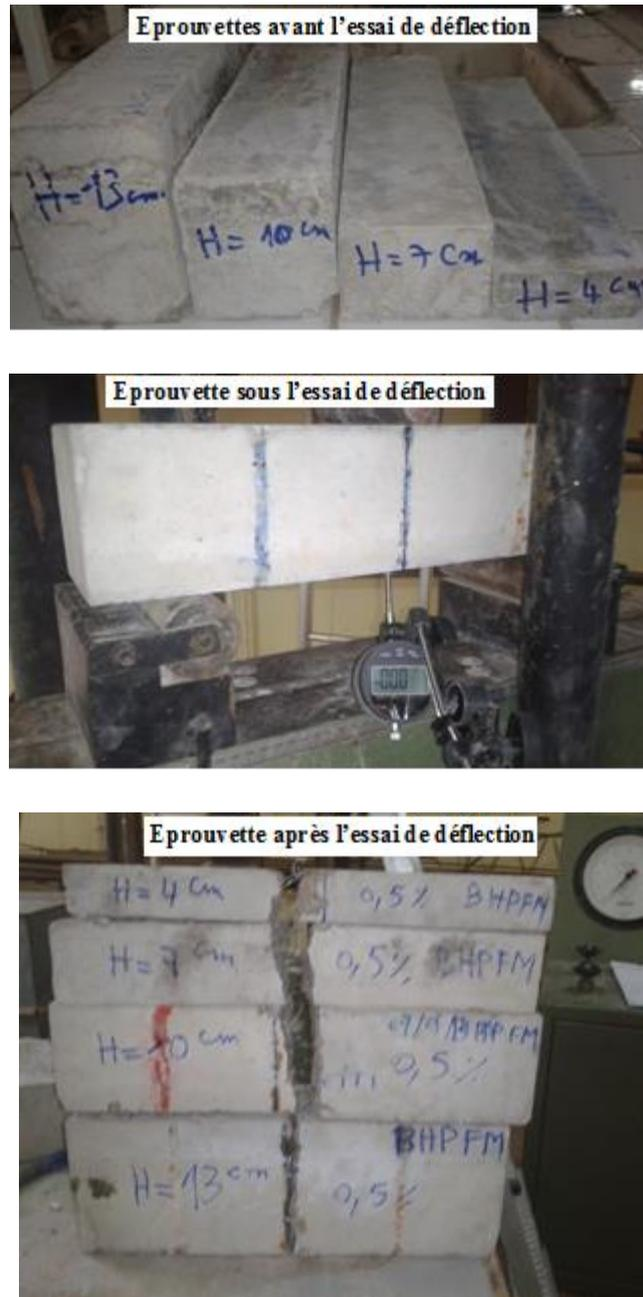
**Figure 3.16 :** Essai de déformabilité (Effet de H).
