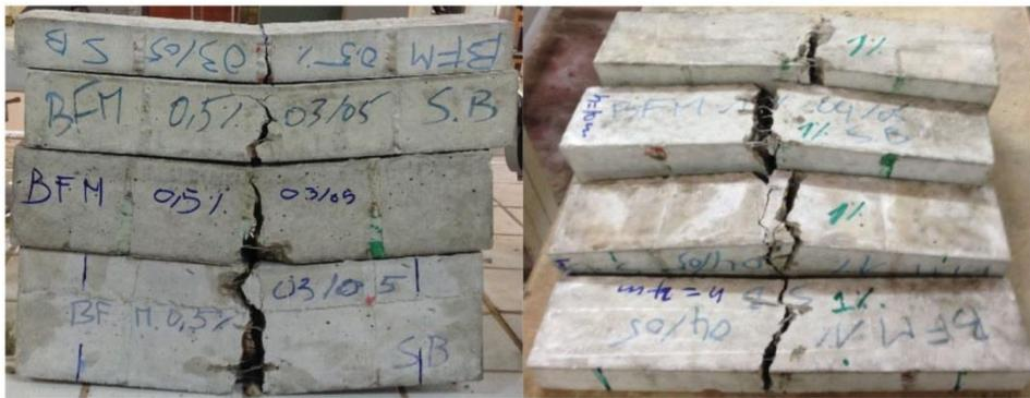
**Figure 4.8 :** *Spécimens après l'essai avec de multiples fissures.*
