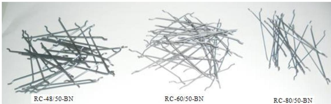
**Figure 3.3 :** Fibres métalliques de type DRAMIX utilisées.
