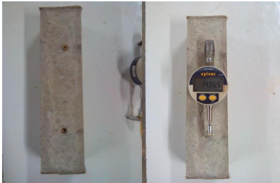
**Figure 3.19 :** Eprouvettes pour mesure du retrait.
