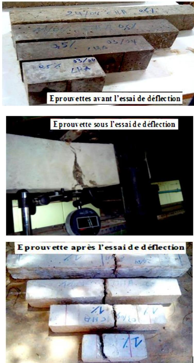
**Figure 3.17 :** Les éprouvettes de déformabilité (Effet de L).
