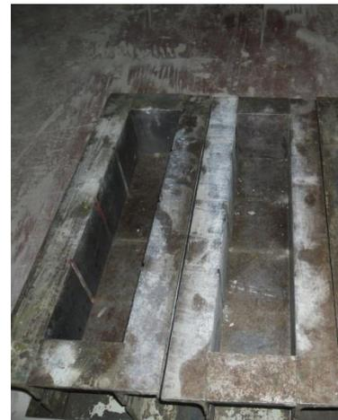
c) Eprouvettes prismatiques 100x100x400 mm (effet d'échelle)
