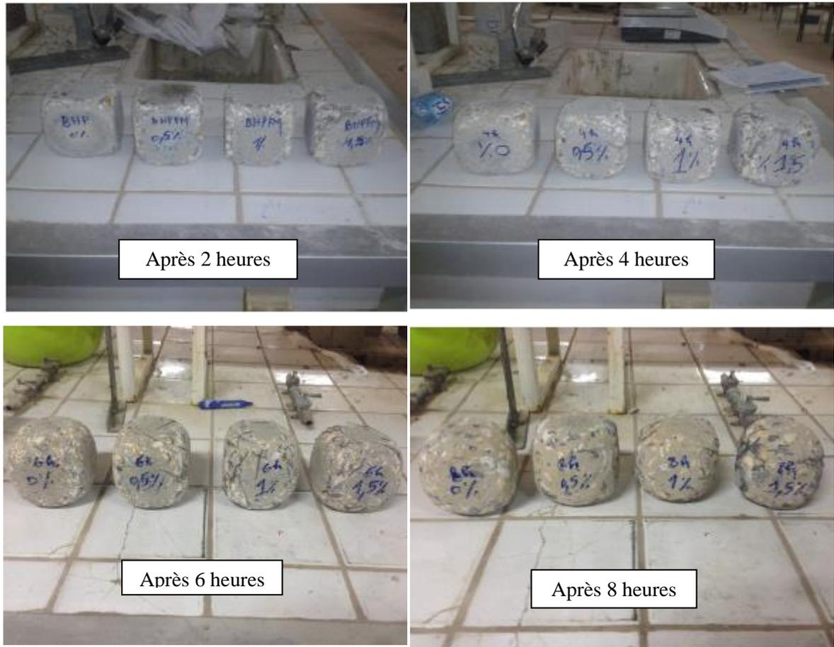
**Figure 4.18 :** *Éprouvettes ayant subi l'essai d'abrasion pendant différentes durées.*
