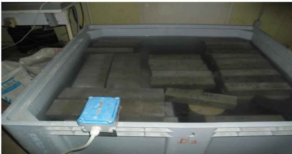
**Figure 3.10 :** Bac de Conservation des éprouvettes.
