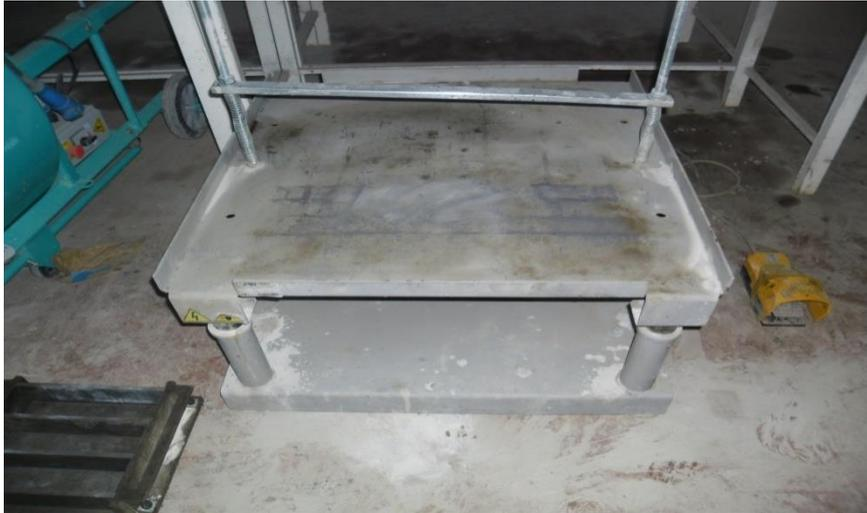
**Figure 3.9 :** Table vibrante utilisé pour le compactage des bétons de fibrés.
