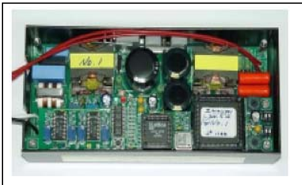
Fig.C-3 : Prototype de ballast électronique pour une lampe à 150 w [4].
