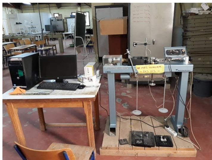
**Figure 3.3 :** Boîte de cisaillement direct du laboratoire de Science des Matériaux et Environnement (LMSE) de l'Université Hassiba Benbouali de Chlef.
