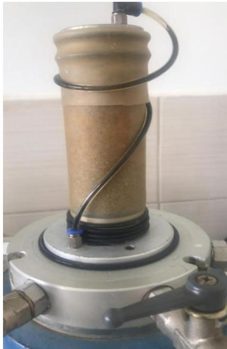
**Figure 3.12** : Phase de démontage du moule.
