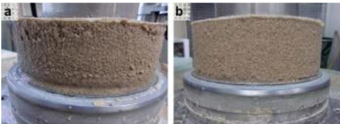
**Figure 2.34** : Deux photos de spécimens denses entièrement liquéfiés après cisaillement :
