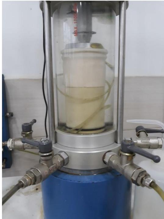
**Figure 3.13** : Cisaillement de l'éprouvette.
