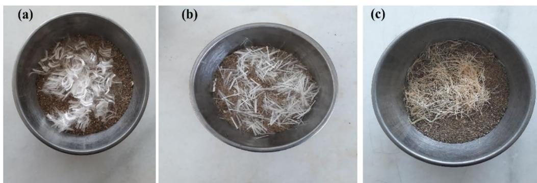
**Figure 3.4 :** Mélange de sable et de fibres : (a) fibre de polypropylène ; (b) fibre de verre ; (c) Fibre de sisal.
