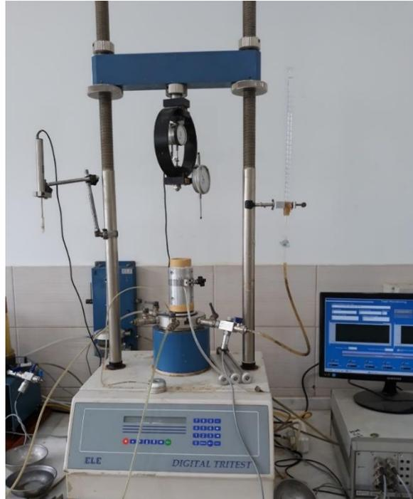
**Figure 3.7 :** Vue générale de l'appareil triaxial.
