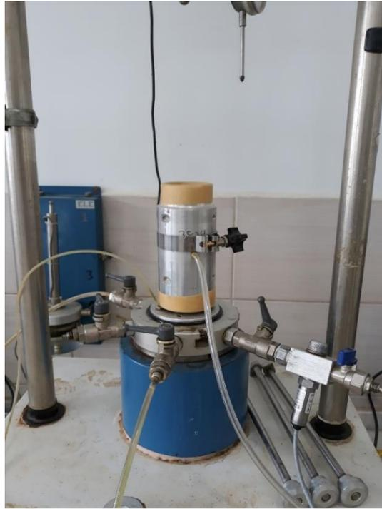
**Figure 3.11** : Mise en place de la membrane et du moule.
