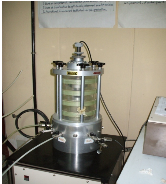
Figure II.10: Mise en place et remplissage de la cellule.
