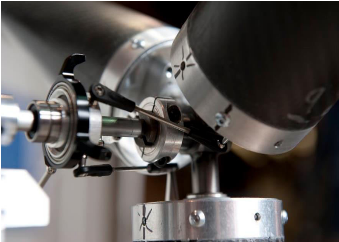
Figure 2.9: Contrôle du calage des pales sur une maquette
