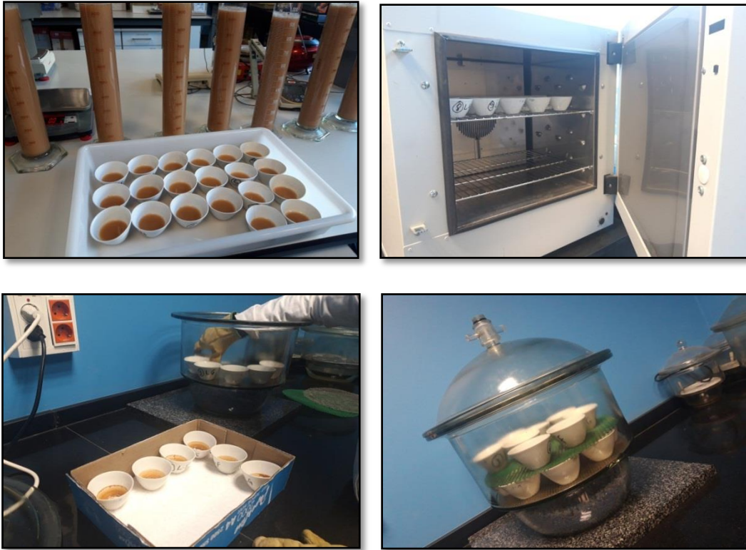
Photo 7 : Mesure de la granulométrie du sol
