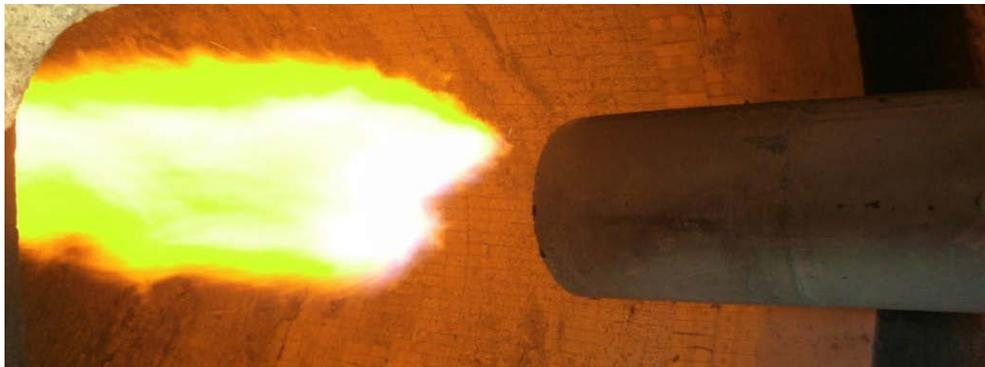
**Figure 21: Instabilité de la flamme de diffusion constaté par un arrachement net. (Brûleur four ECDE Chlef)**
