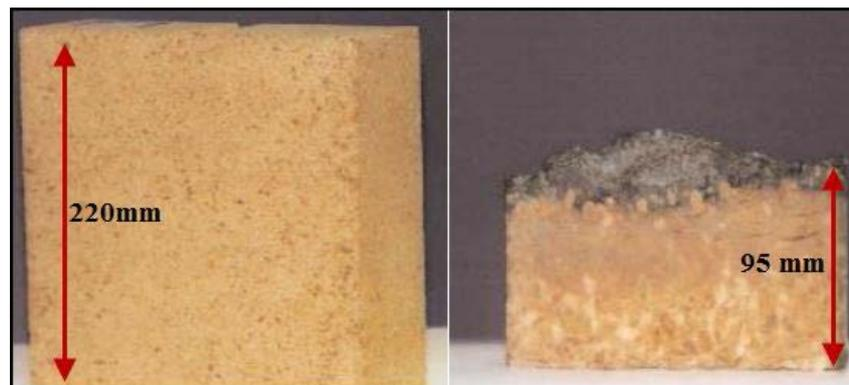
**Figure 15 : Échantillon de brique réfractaire affecté par la flamme dans un four de cimenterie (documentation ECDE)**
