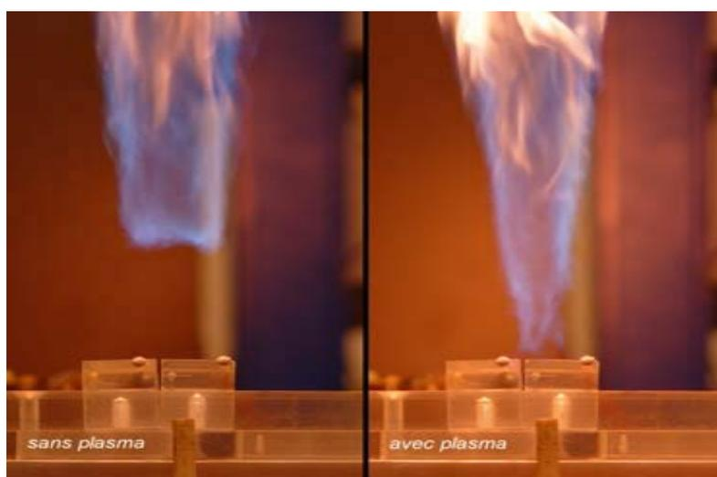
Figure 23: Stabilisation d'une flamme-turbulente de propane à l'aide d'une impulsion haute tension ultra brève [41]
