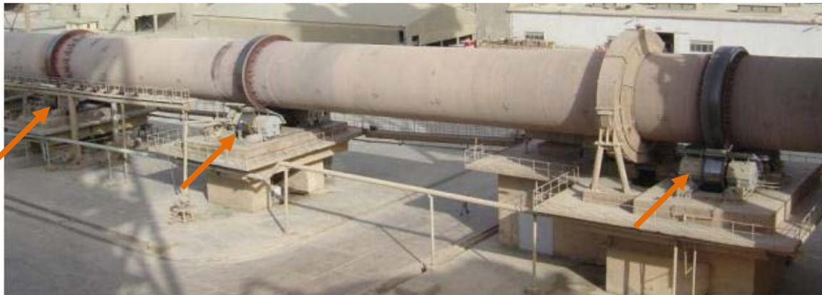
**Figure 4 : Four rotatif porté sur les stations de roulements (flèches), à ECDE Chlef**
