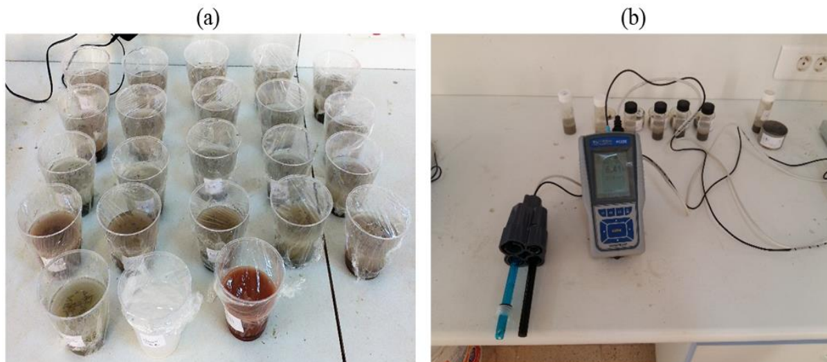
Fig. 3.12 — Tests de détermination du pH. (a) Préparation des échantillons, (b) pH-mètre utilisé.
