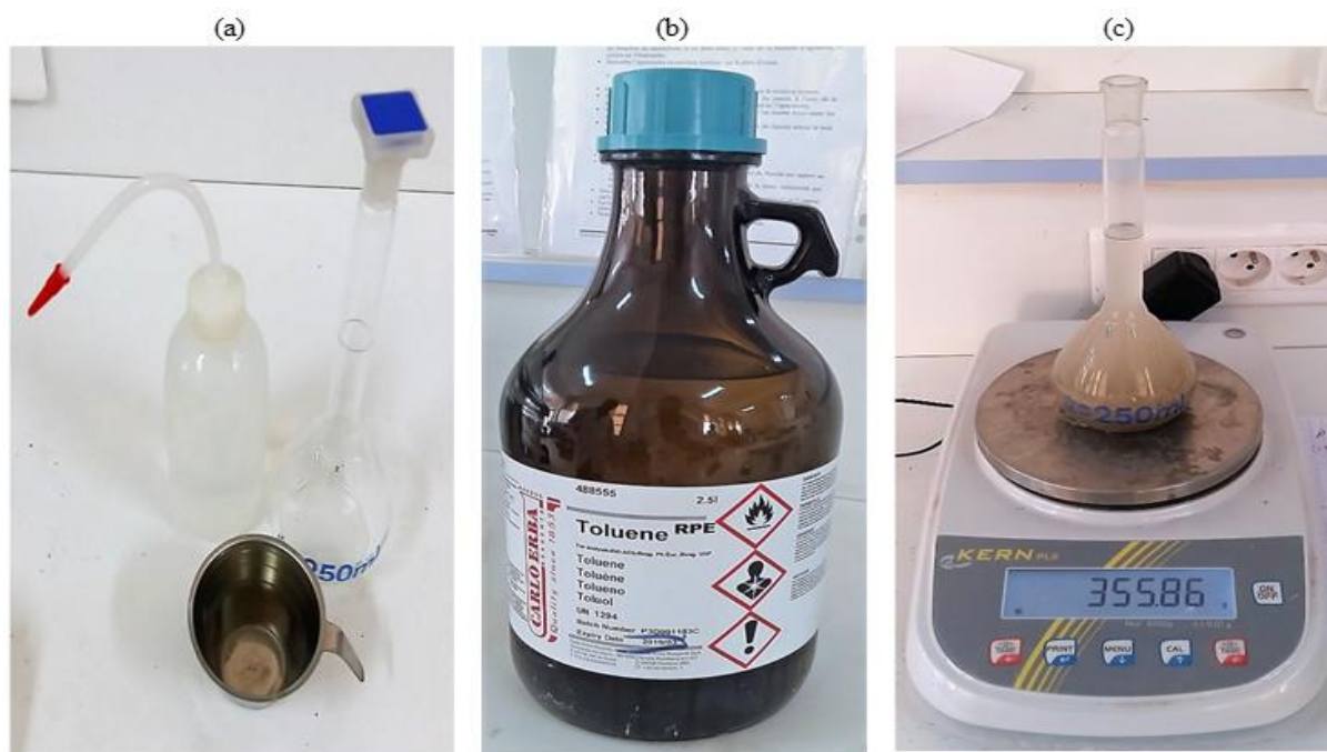
Fig. 3.13 — Essais de la densité spécifique. (a) l'équipement utilisé, (b) Toluène, (c) pesage de la masse d'échantillon
