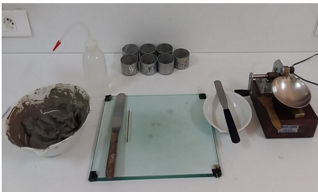
Fig. 3.14 — Dispositif utilisé dans le test limite d'Atterberg selon ASTM D 4318-17.
