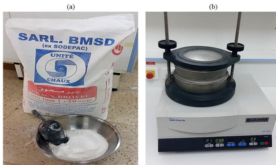
Fig. 3.8 — Préparation de la chaux. (a) emballage utilisé pour la chaux de Saïda, (b) tamisage au tamis 0.4 mm
