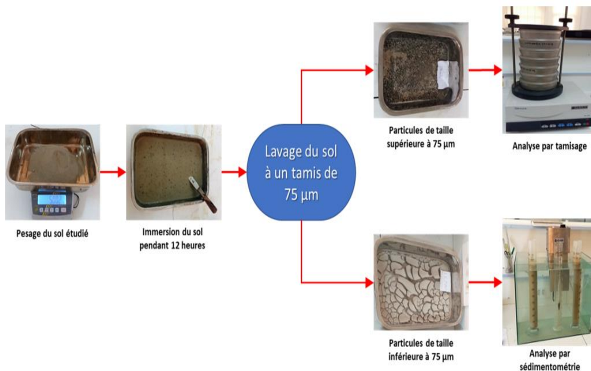
Fig. 3.21 — Les étapes d'analyse granulométrique
